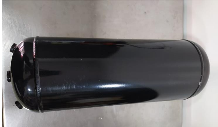
Figura 2.4. Acumulador de presión.
