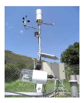
Nota. Estación automática para Hidroagoyan en Baños: el sensor de duración de radiación de LSI LASTEM.
