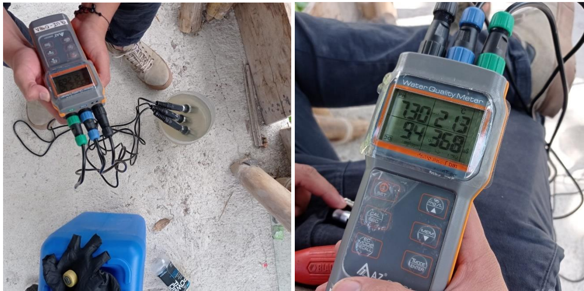
Anexo 8. Medición de parámetros In Situ (Oxígeno disuelto, pH, temperatura y conductividad)
