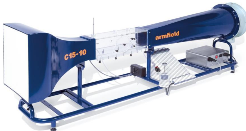
Túnel de viento subsónico con conexión a PC, TecnoEdu (s.f.)
