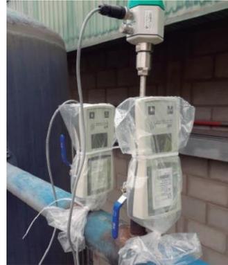
Figura 4. Sensores de presión
