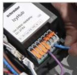
El módulo IzyHub a prueba de fallos facilita la conexión eléctrica en la instalación y durante operaciones de mantenimiento.
