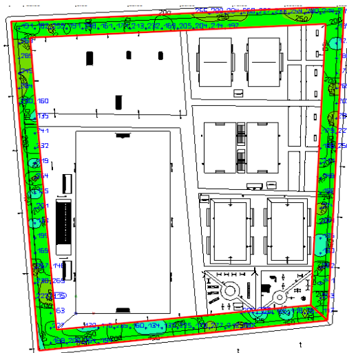
Figura 16 Resultados luminotécnicos de la pista. Fuente: Autor.
