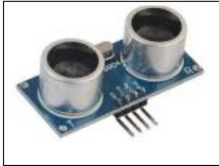
Fig. 2 Sensor de proximidad HC-SR04 [3]
