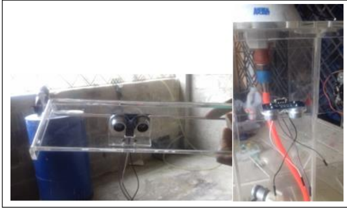
Fig. 59 Instalación del sensor ultrasónico. (AUTOR)
