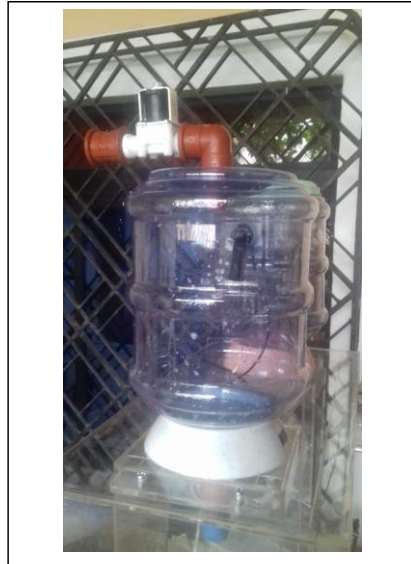
Fig. 61 Instalación de la electroválvula N/A (AUTOR)
