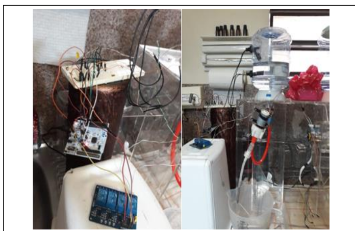
Fig. 53 Se realizan pruebas con el motor de diafragma o bomba de agua (AUTOR)
