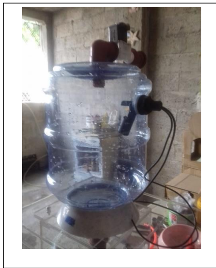
Fig. 60 Instalación del sensor de nivel (AUTOR)
