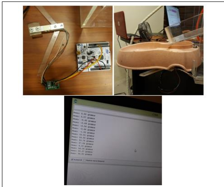
Fig. 44 Pruebas con el sensor de peso (AUTOR)
