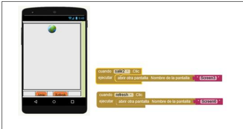
Fig. 72 Diseño y programación del screen 4 (AUTOR)
