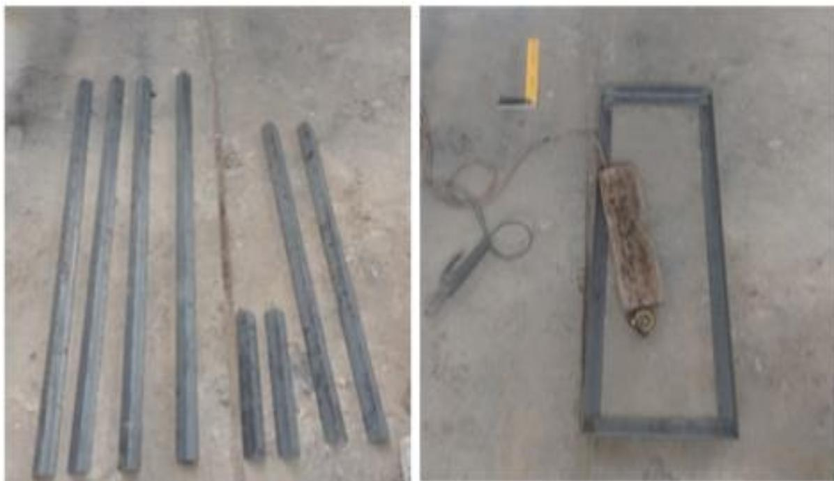
**Figura 13.** Diseño para base de compresor Chiller
