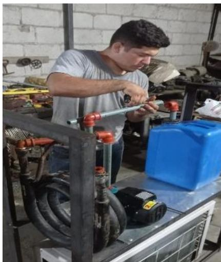
**Figura 15.** Colocación de tubos de cobre y tuberías PVC
