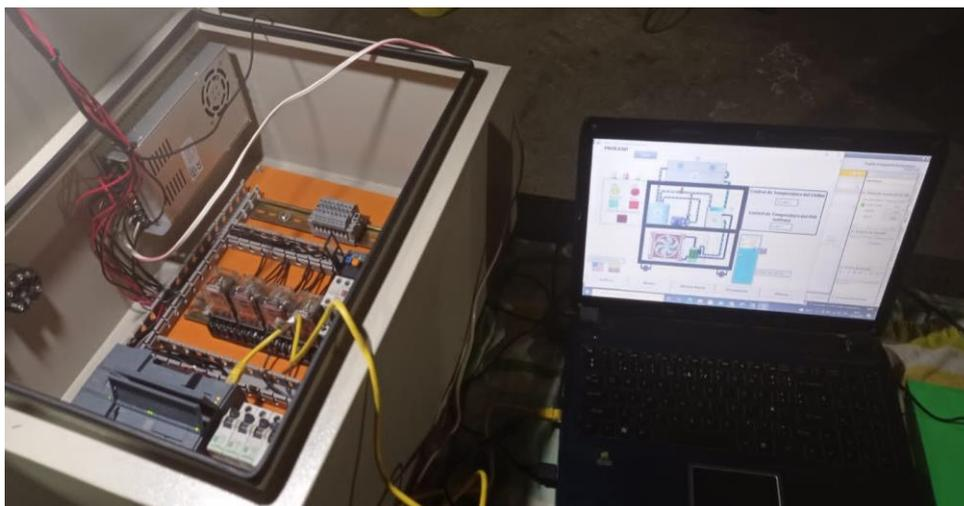
**Figura 24.** Prueba piloto del sistema del PLC conectado al computador
