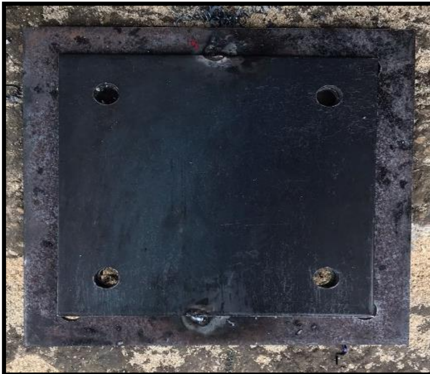
Figura 50: Platina de 4mm para soportar y estabilizar el poste a utilizar, fuente: Los Autores.
