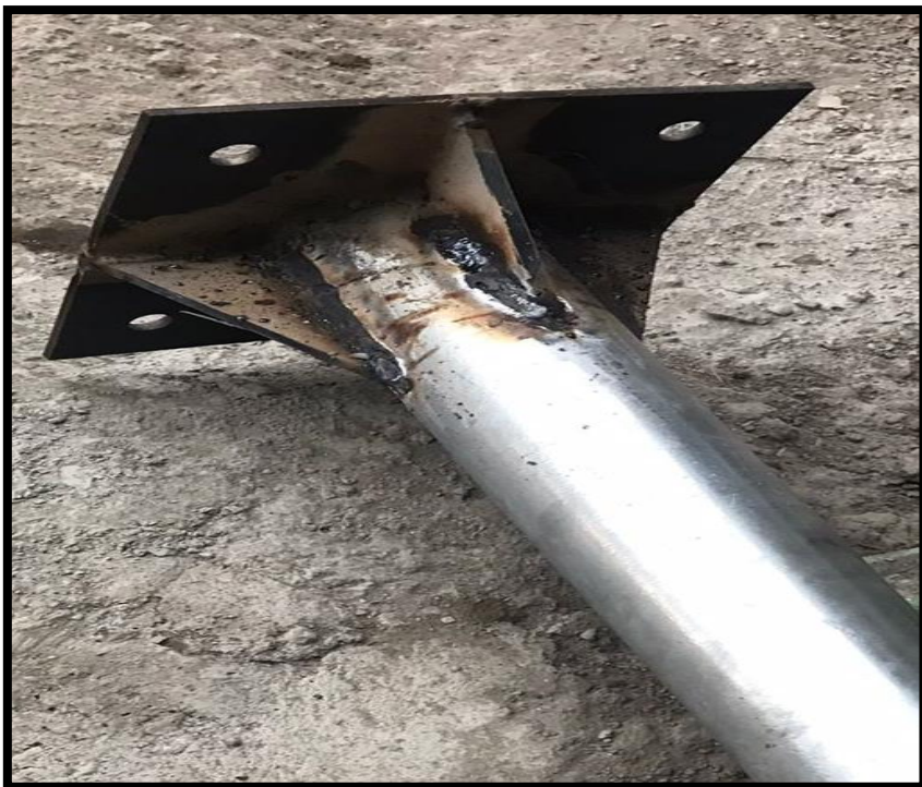
Figura 52: Acoplamiento de platina y alerones a la tubería de 3' para mayor soporte y estabilidad, fuente: Los Autores.
