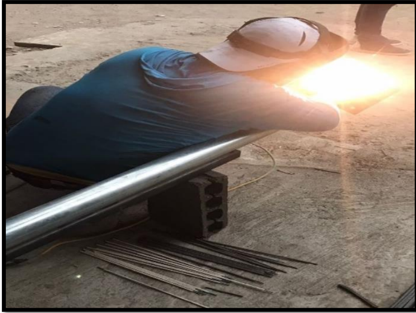
Figura 53: Soldadura de las respectivas piezas del tubo de soporte o poste en el taller, fuente: Los Autores.
