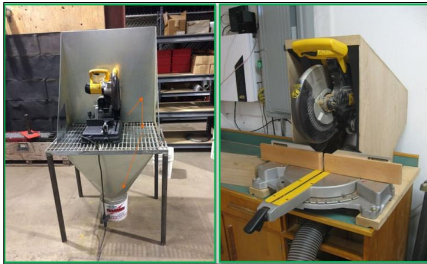
Figura 13 Eliminar fuentes de suciedad
