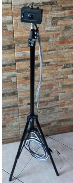
Figura 4.5: Sistema de visión artificial.
