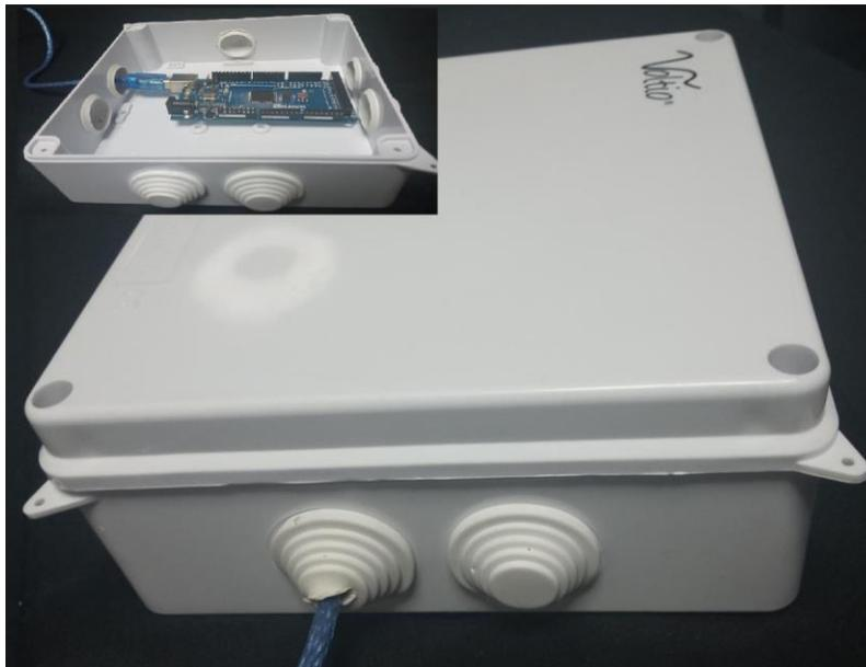
Figura 4.8: Tarjeta de Adquisición ensamblada.
