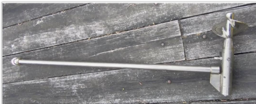
Figura 4.19. Equipo utilizado para el aforamiento (molinete)
