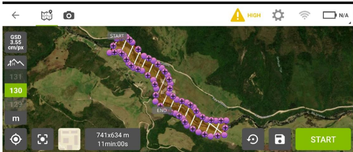
Ilustración 15. Trazo del polígono de referencia en PIX4D Capture.
