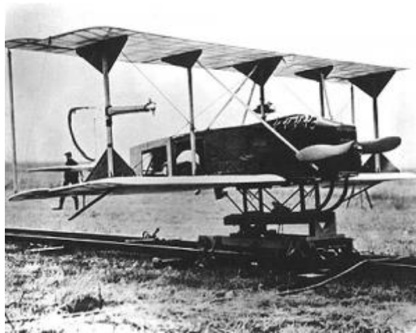
Ilustración 3 Avión automático "Hewitt-Sperry"
