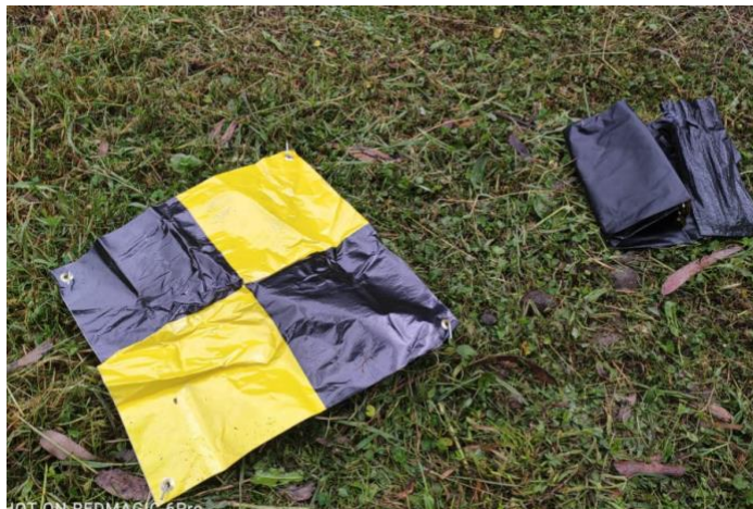
Ilustración 18. Punto de control para levantamiento fotogramétrico.
