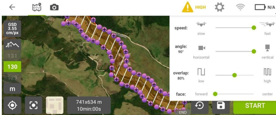
Ilustración 21. Trazado del polígono con la misión de vuelo del proyecto cinco.
