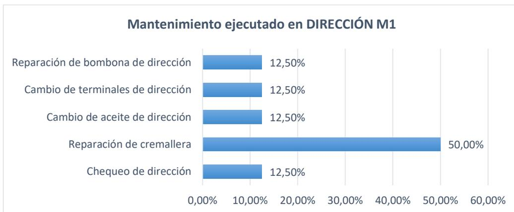
*Ilustración 44 Porcentajes de mantenimientos ejecutados en el sistema de dirección M1. Fuente Autores*
