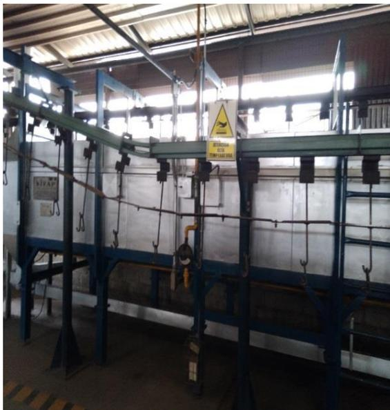
*Nota. Esta máquina nos ayuda a eliminar las tensiones de los cilindros de gas. Tomado de la Empresa Tecnero S.A*
