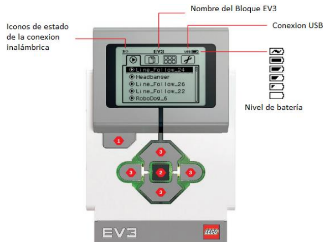
Disposición de la pantalla y el bloque EV3, Fuente (Vizcaíno Juan, 2017)
