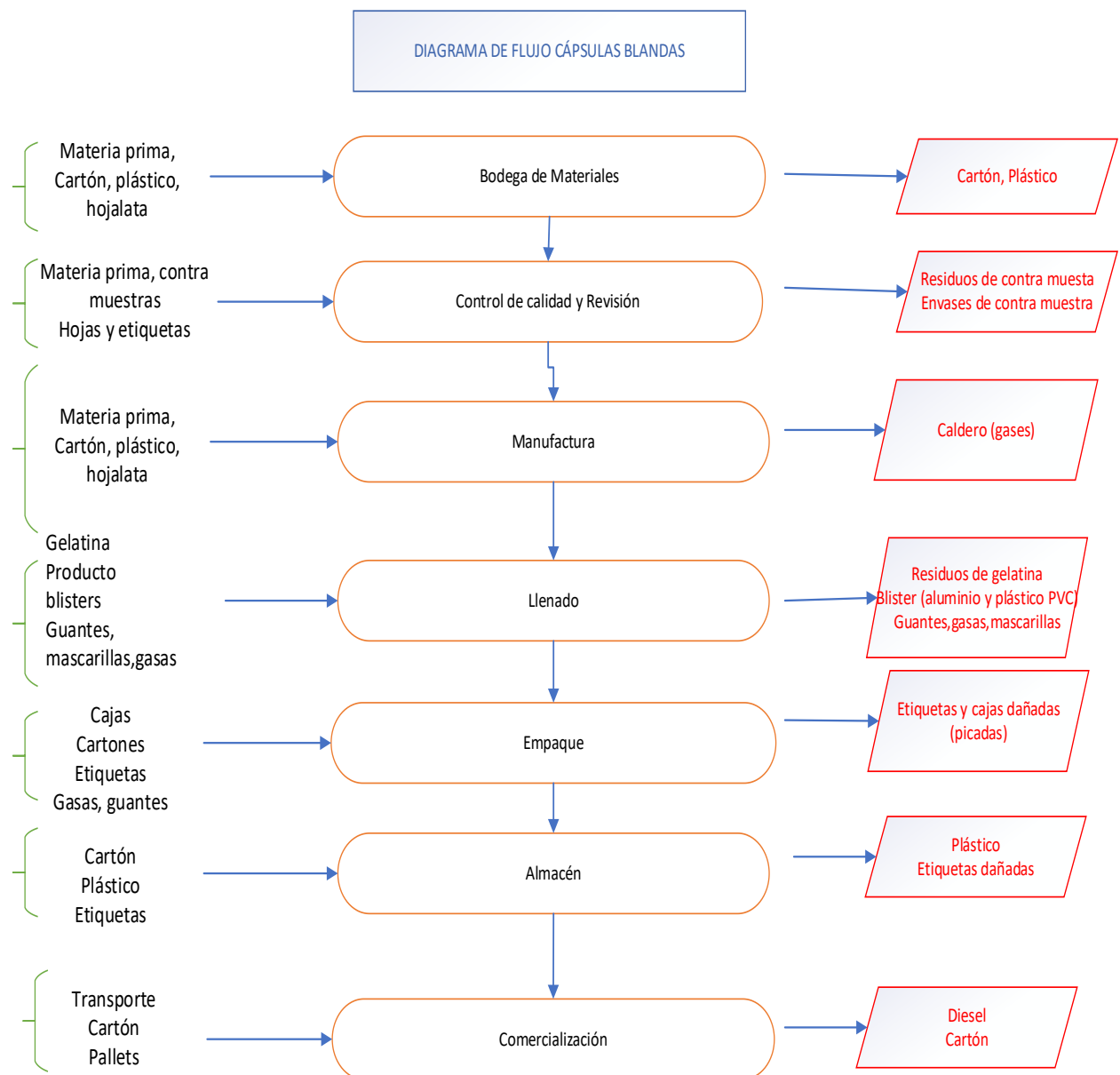
Diagrama de flujo de producción de Cápsulas blandas
