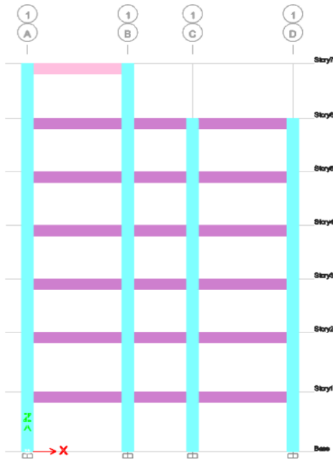
Figura 13: Pórtico en sentido "x" del bloque 2.
