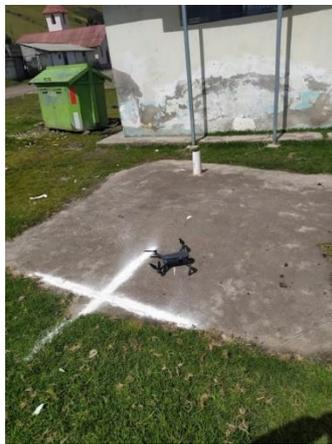
*Nota.* Vuelo de dron y colocación de marcas en BMs. Elaborado por: El autor
