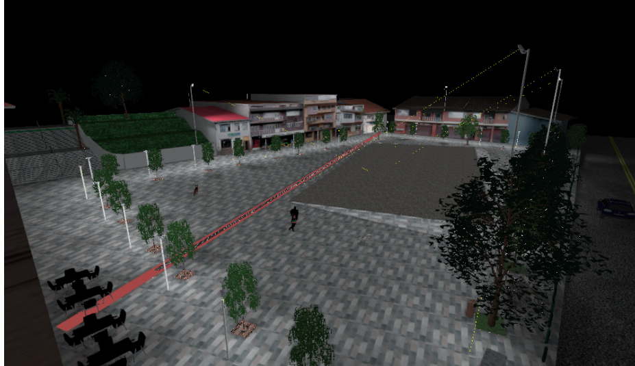
Figura 103: Vista iluminada de la plaza en el software DialuxEvo. Fuente: Los autores.
