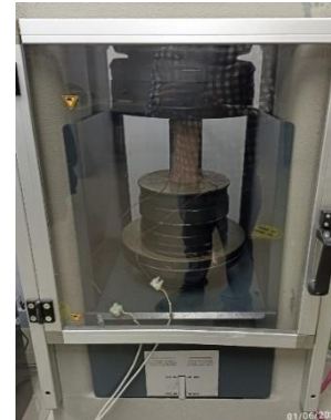
Figura 7. Medición del módulo elástico mediante galgas extensiométricas y equipo de adquisición de datos.
