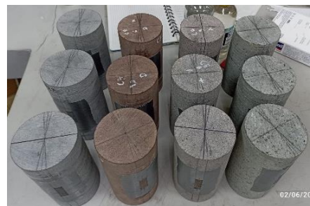
Figura 5. Testigos de roca preparados
