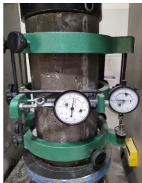
Figura 6. Método tradicional empleado en cilindros de hormigón para la determinación del módulo elástico.
