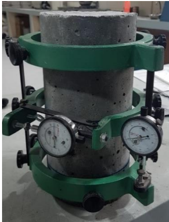
Figura 3. Especimen para ensayo del módulo de elasticidad.
