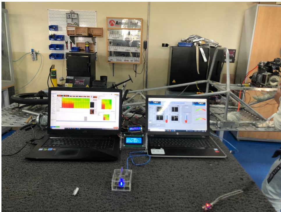
Figura 4.20. Sistema de telemetría funcionando.
