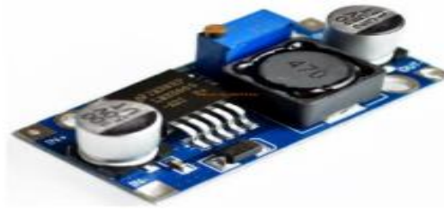
Figura 3.4. Regulador DC-DC LM2596.
