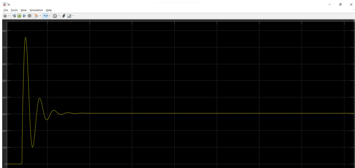
Figura 5.9: Resultados de par eléctrico a 300 rpm en Matlab/Simulink
