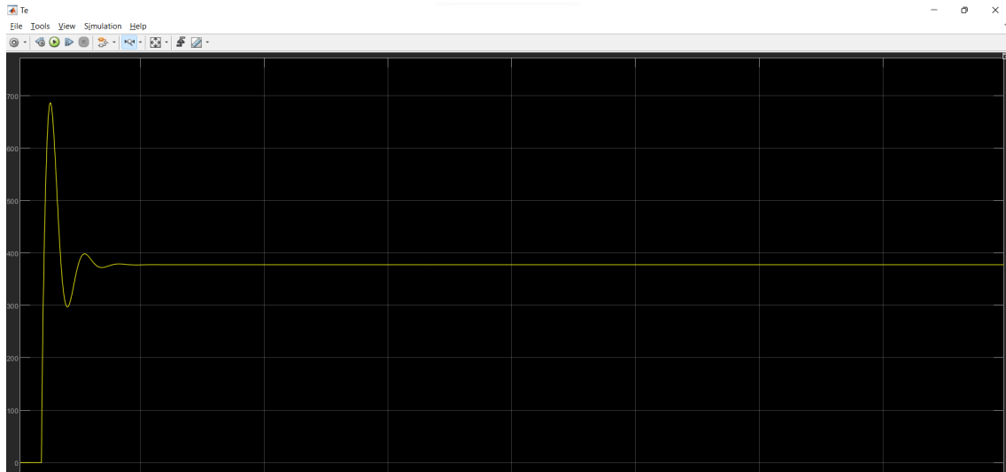
Figura 5.6: Resultados de par eléctrico a 180 rpm en Matlab/Simulink
