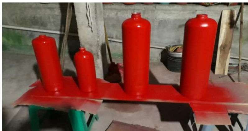
Figura 49: Pintado de un extintor
