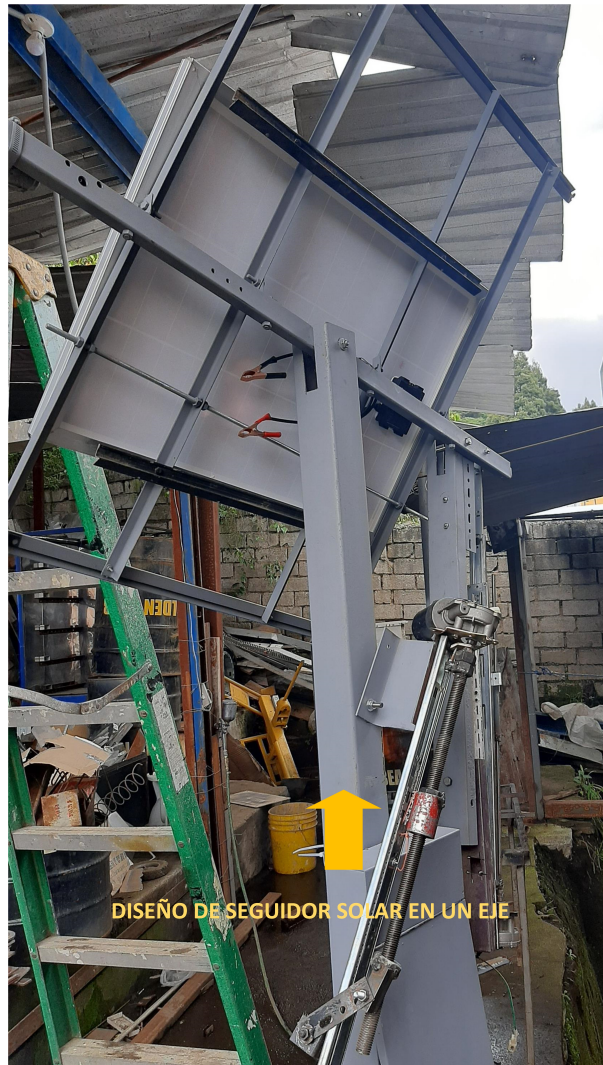
Figura 2.5: Seguidor en un eje.
