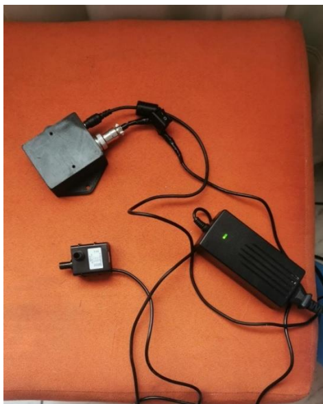
Figura 40 Bomba de agua.
