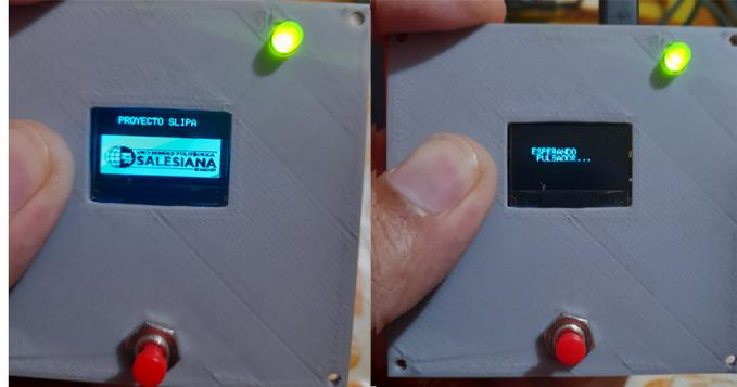
Figura 4.2: Dispositivo receptor.- espera a presionar botón búsqueda
