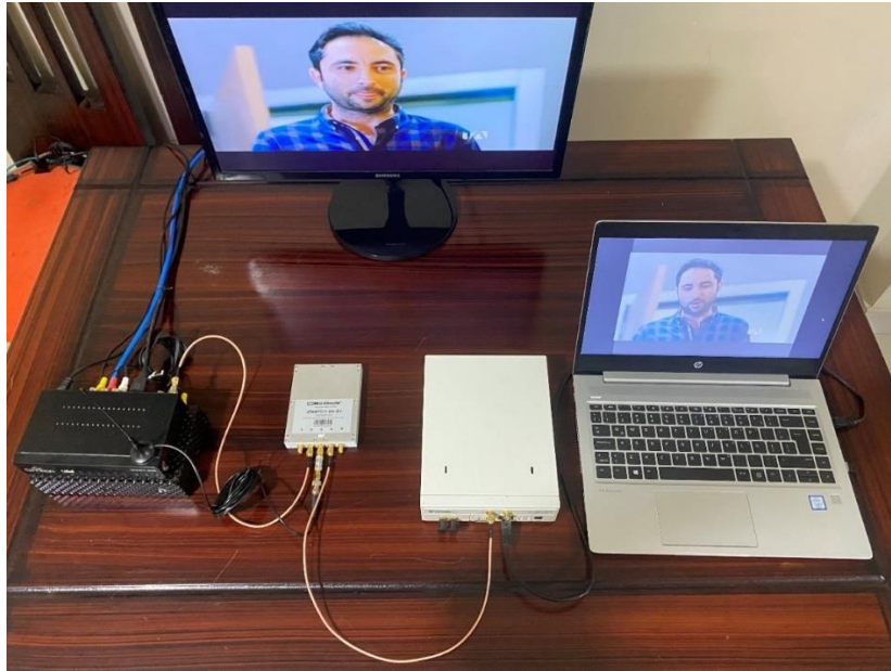
Figura 4.5 Banco de pruebas con USRP y Decodificador ISDBT
