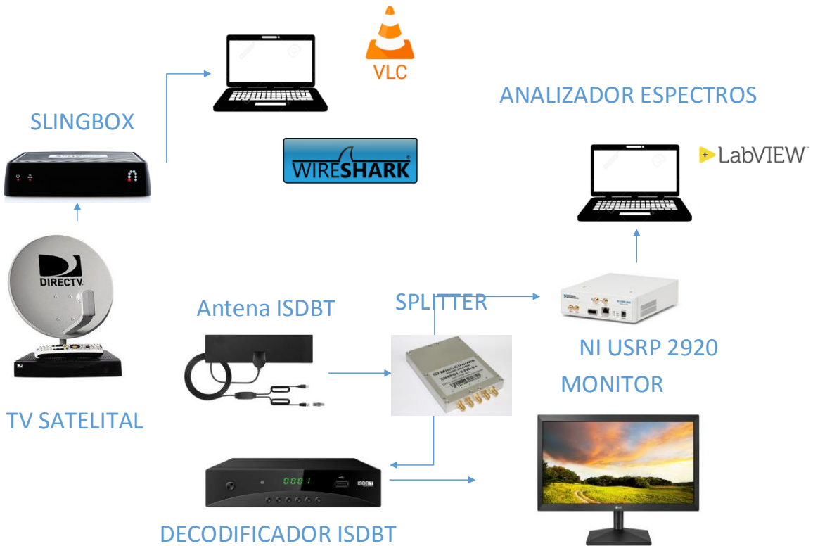
Figura 3.1 Diseño de banco de pruebas de televisión digital
