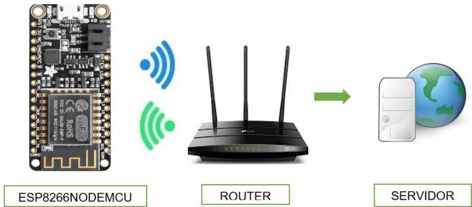
Figura 21 Diagrama de conexión de datos de la tarjeta ESP8266NodeMCU al sistema de monitoreo.
