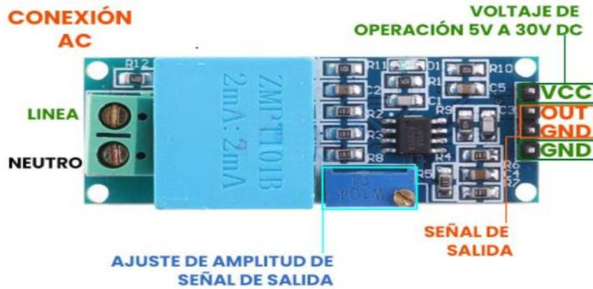
Figura 15 Sensor de voltaje zmpt101b [35].
