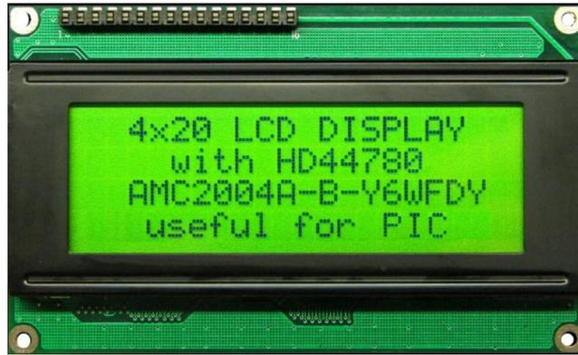
Figura 18 Pantalla LCD 20X4 [42].
