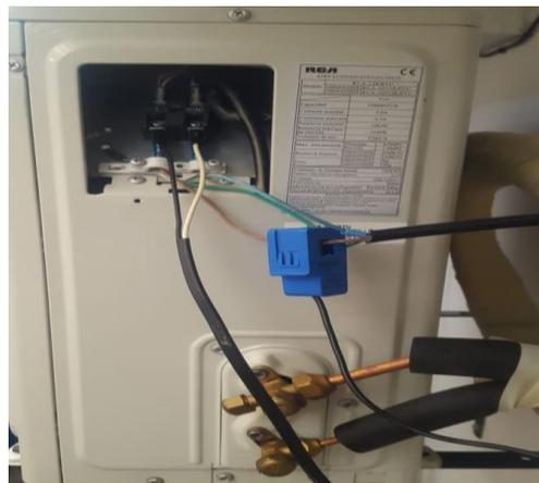
Figura 53 Conexión de sensor de voltaje y corriente.
