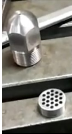
Figura 26. Diseño de Cabezal y Boquilla mecanizadas
