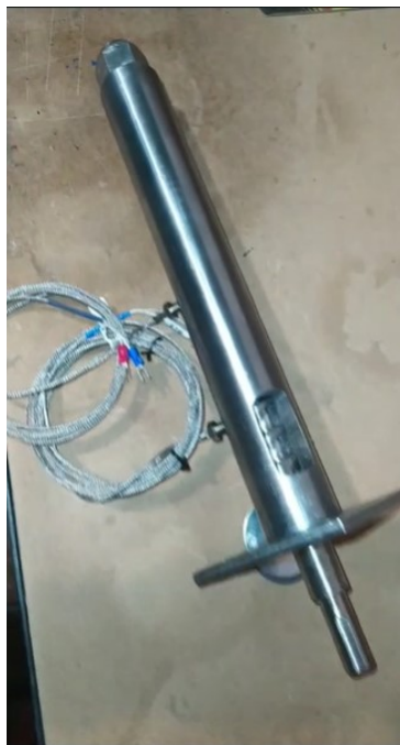
Figura 23. Diseño de Barril mecanizado, con boquilla, plato rompedor, plato de soporte y termocuplas acopladas
