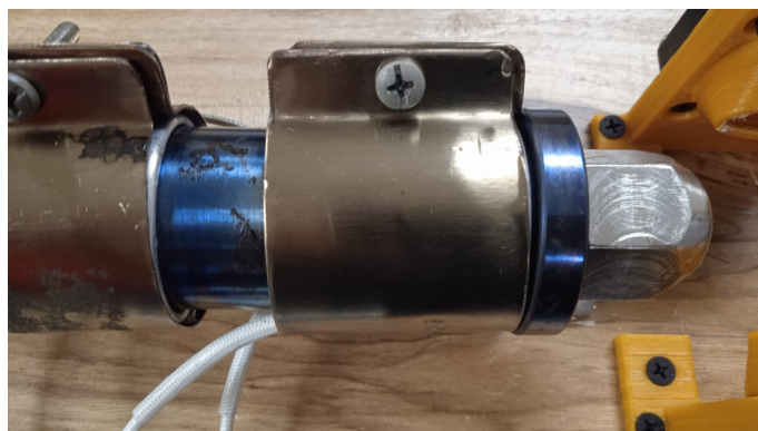
Figura 46. Cilindro de color azul por altas temperaturas
