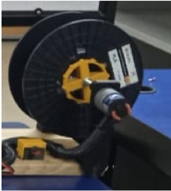
Figura 39. Sistema de bobinado implementado en maqueta
