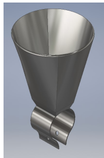
Figura 28. Diseño de Tolva en Inventor 2019
