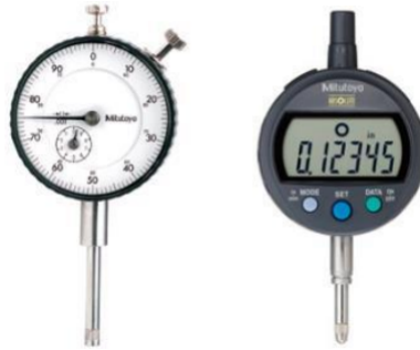
Figura 8. Indicador de diámetro (Reloj Comparador) de carátula y digital Reloj comparador digital y de carátula [2]
