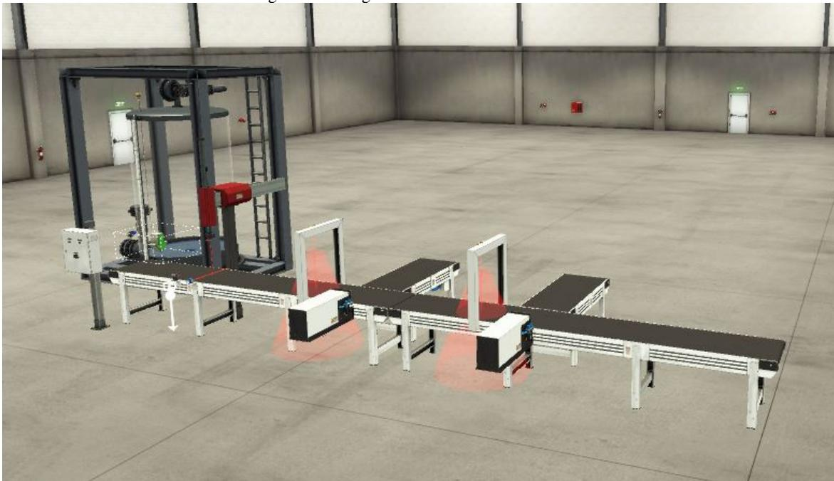
*XII-D2. TIA PORTAL:* La programación se realizó por diagrama lógico de contactos y por segmentos que cumplan con los requerimientos de la banda, en otras palabras, que ejecute la clasificación conforme a los envases de colores y rechace los recipientes que contengan material metálico.
