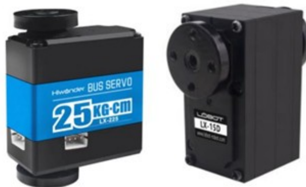
Figura 7. Motores LX-225 y LX-15D, [12]
