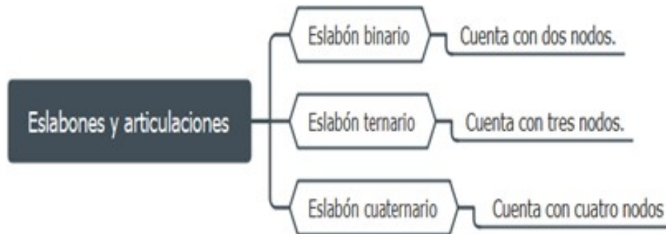
Figura 6. Clasificación de eslabones, Elaboración propia.
