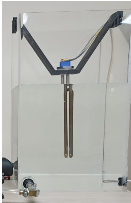
Figura 40. Tanque de temperatura con el nivel máximo a controlar. Fuente: Los autores
