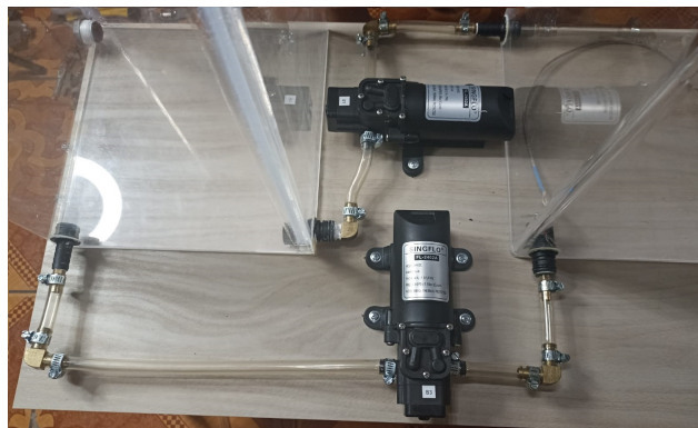
Figura 28. Enrutamiento de las tuberías. Fuente: Los autores.
