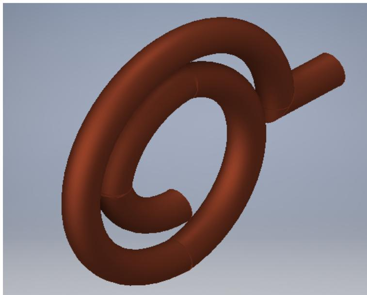
Figura 21. Tubería por donde se conducirá el aire caliente. [Ilustración 21], por W. Gutiérrez y A. García, Inventor Autodesk, 2021
