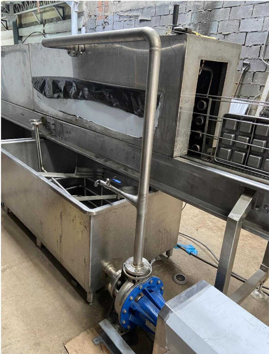
Figura 79. Integración de bombas a sistema de lavado
