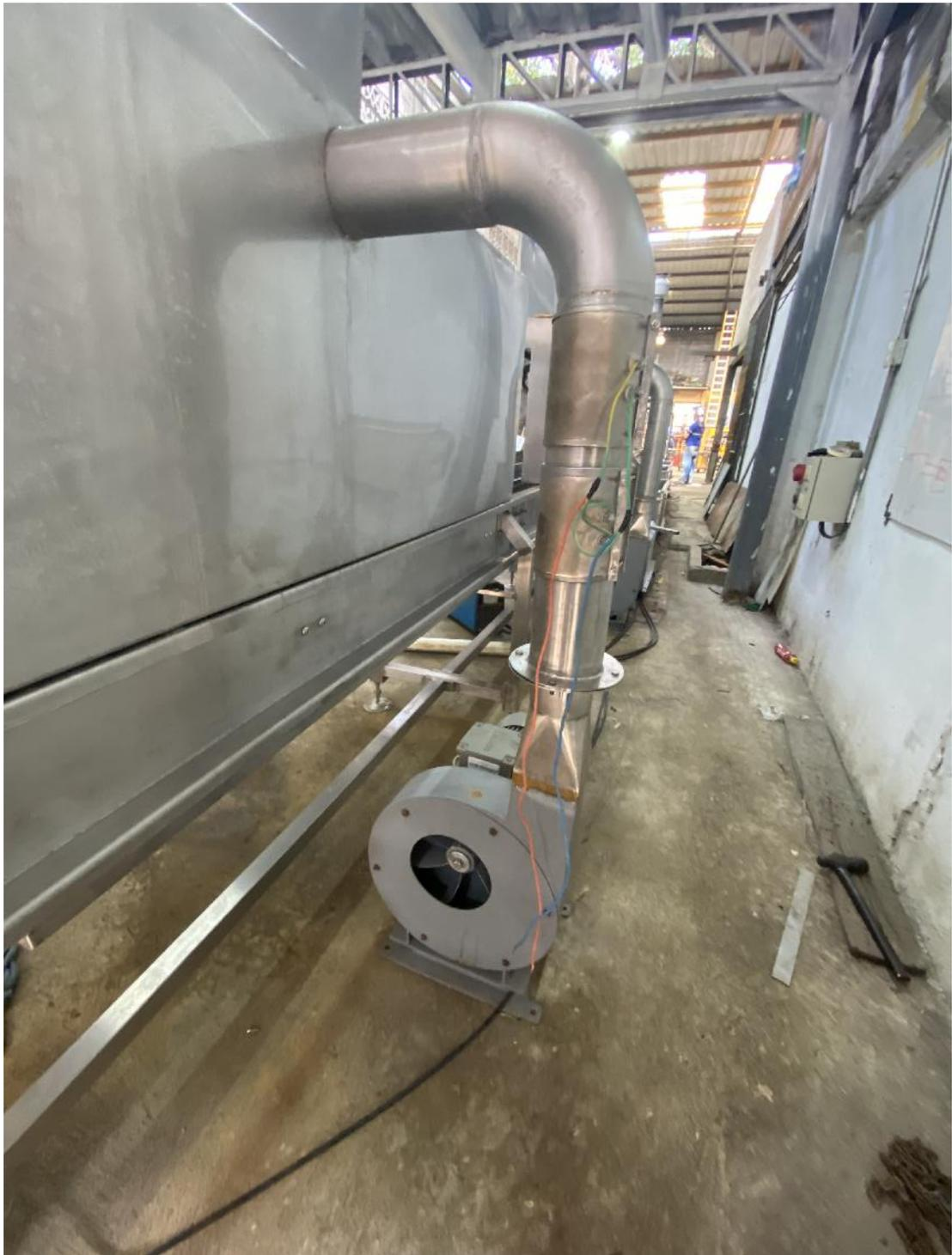
Figura 87. Integración de sistema de ventilación a cabina de secado
