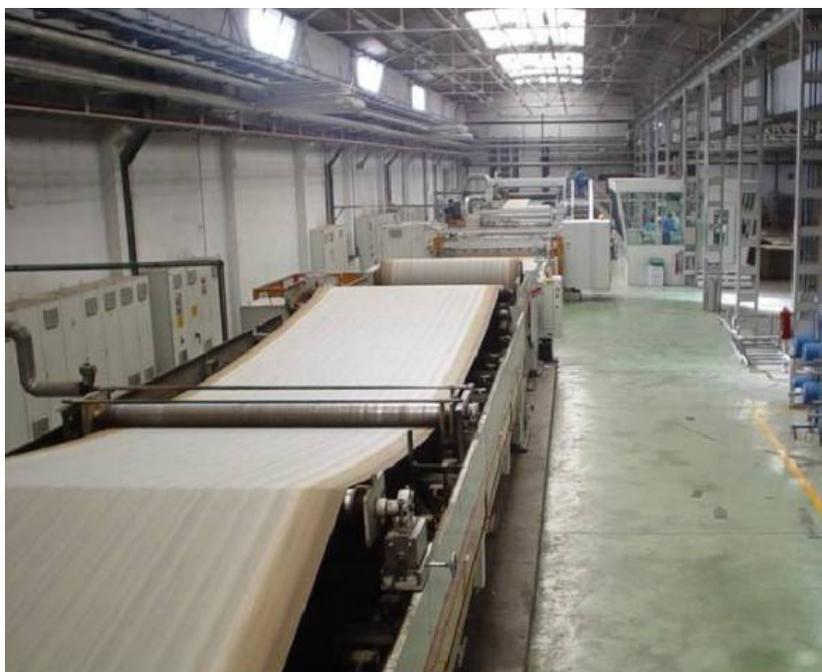
Figura 23. Secadora por conducción
