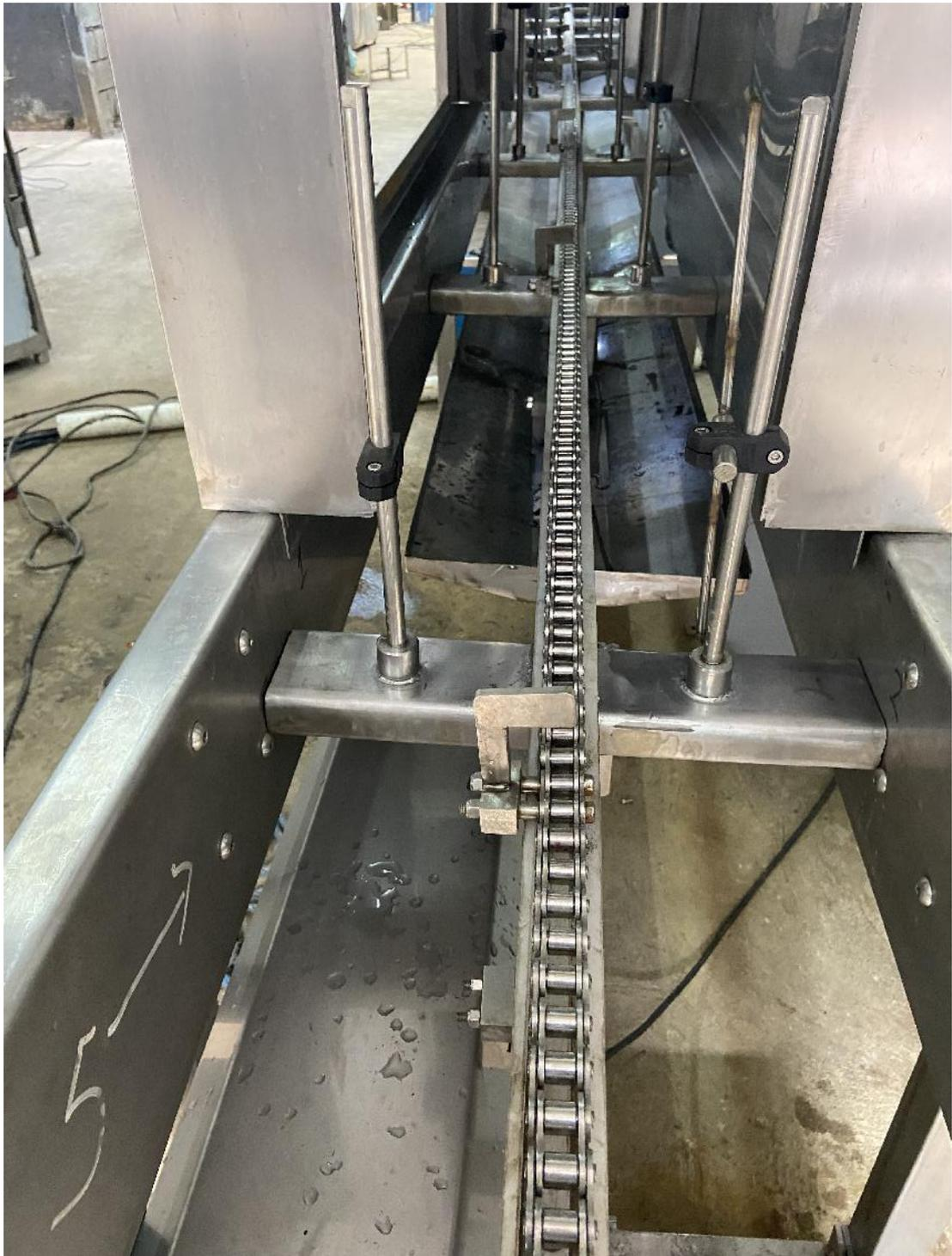
Figura 72. Instalación de cadena sobre canal de teflón
