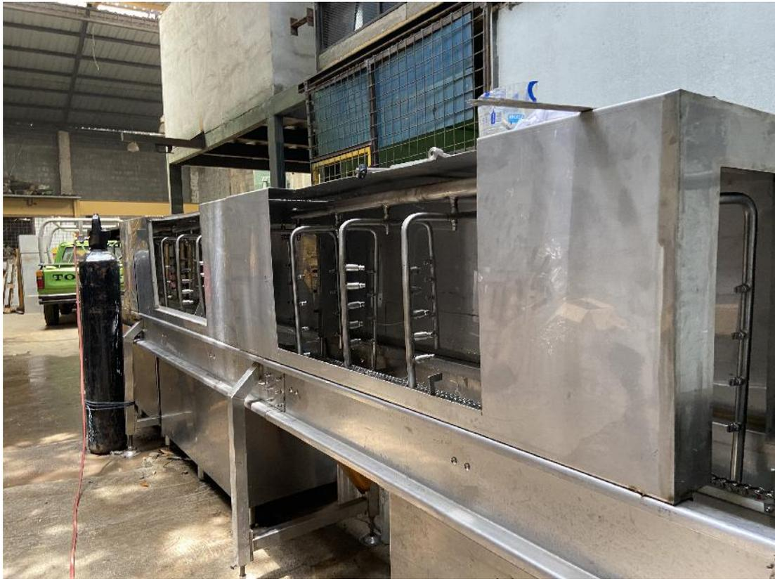
Figura 77. Ensamble de cabinas de lavado de la máquina
