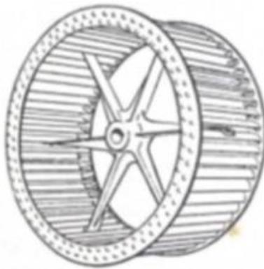
Figura 36. Hélices curvas hacia delante (forward)
