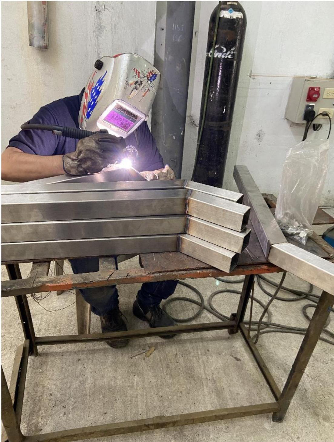
Figura 61. Aplicación de soldadura a tubos cuadrados que formarán las bases del equipo
