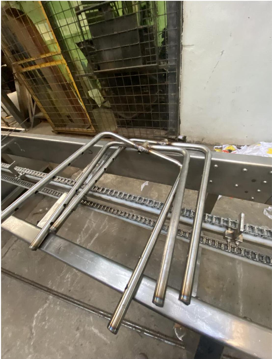
Figura 75. Confección de anillos para instalación de boquillas
