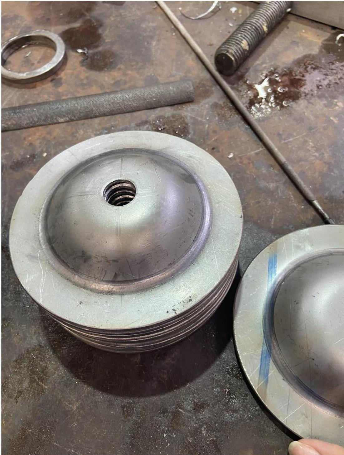
Figura 64. Patas de la base del túnel de lavado confeccionadas
