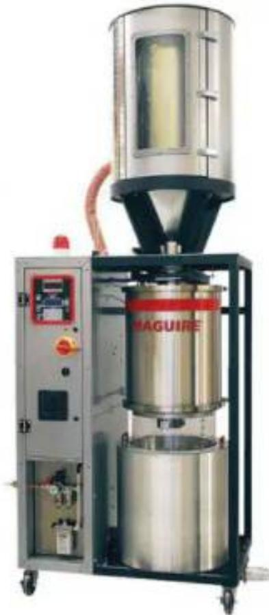
Figura 26. Secadora por vacio
