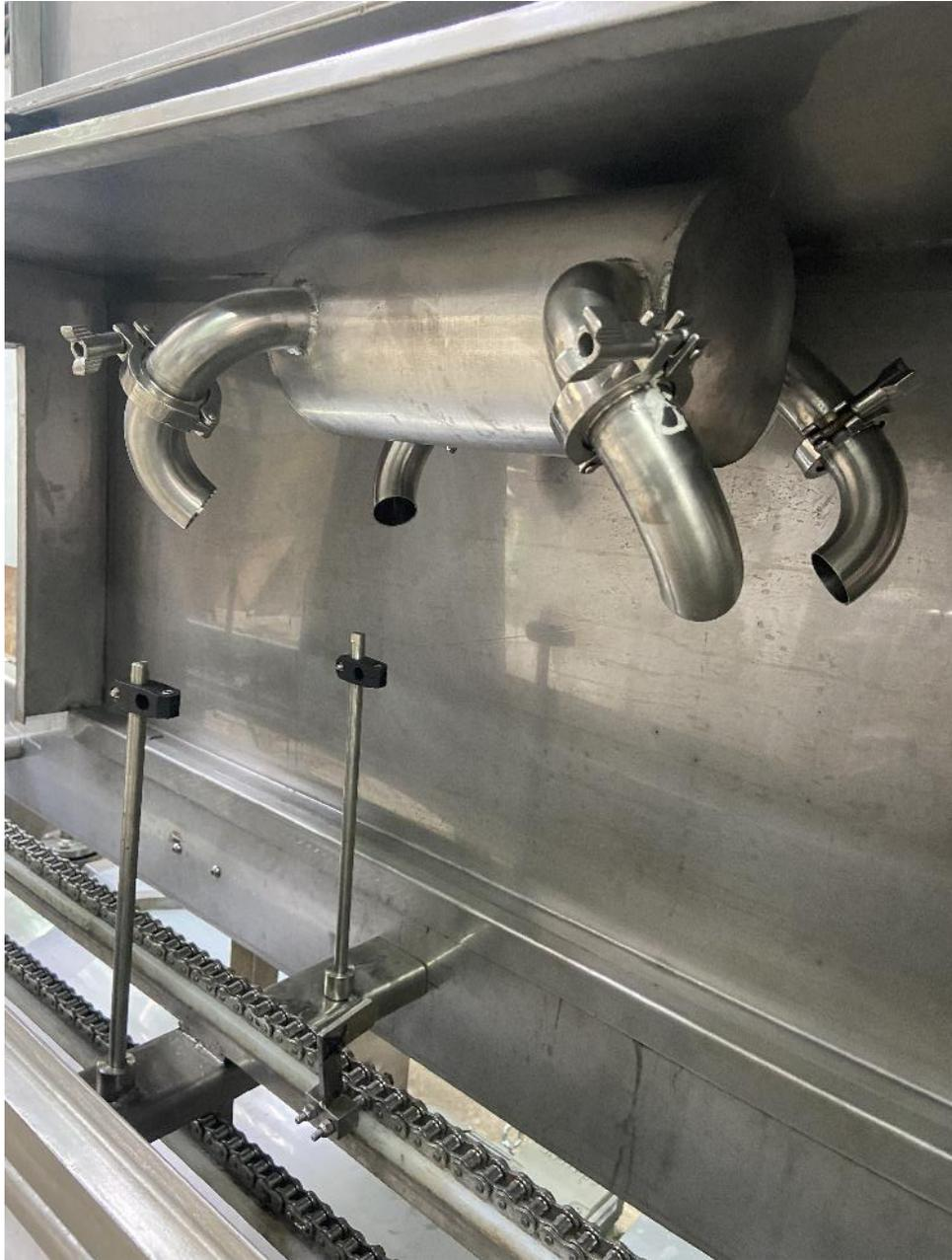
Figura 86. Ducto distribuidor de aire montado
