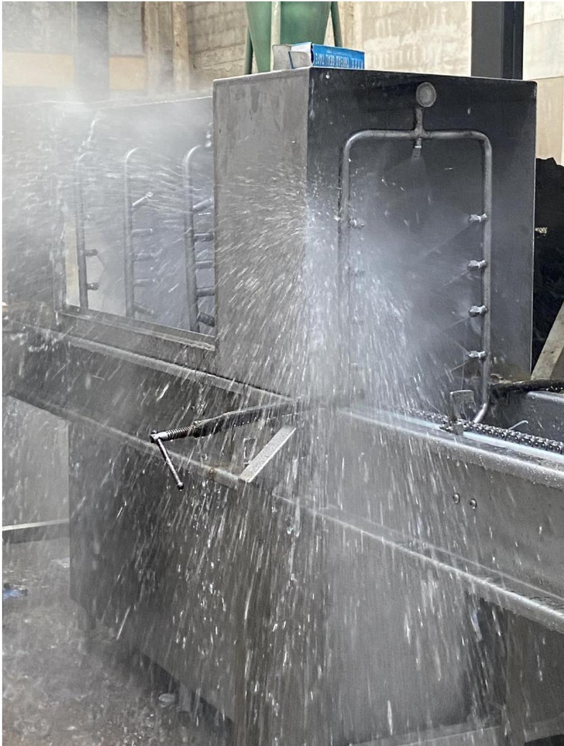
Figura 81. Prueba de funcionamiento de aspersores
