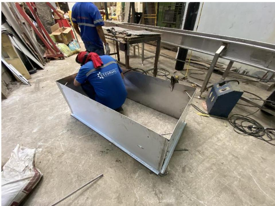
Figura 73. Confección de tanques de agua, ensamble de planchas para aplicación de soldadura
