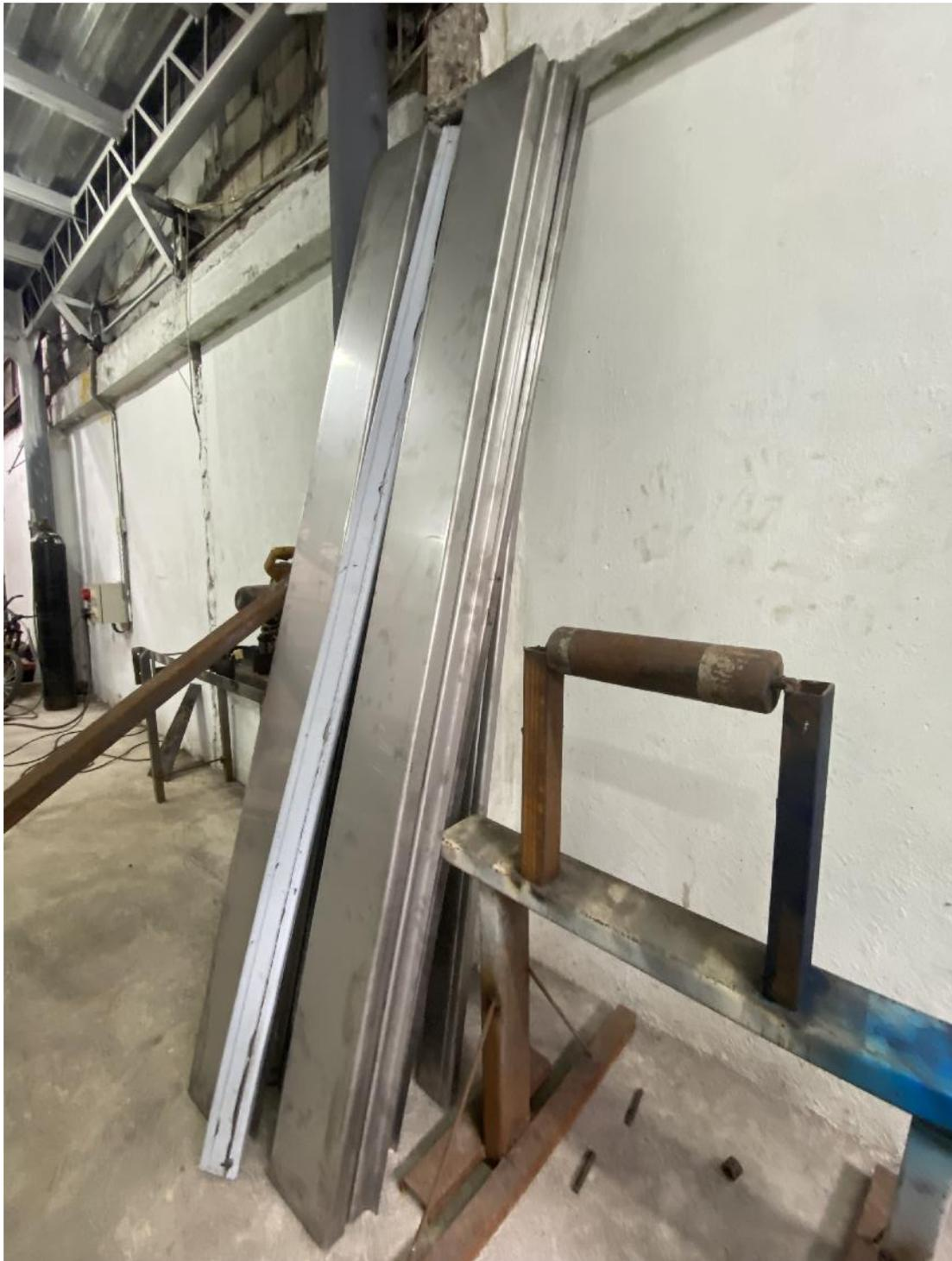
Figura 57. Planchas cortadas para el conformado de perfiles.
