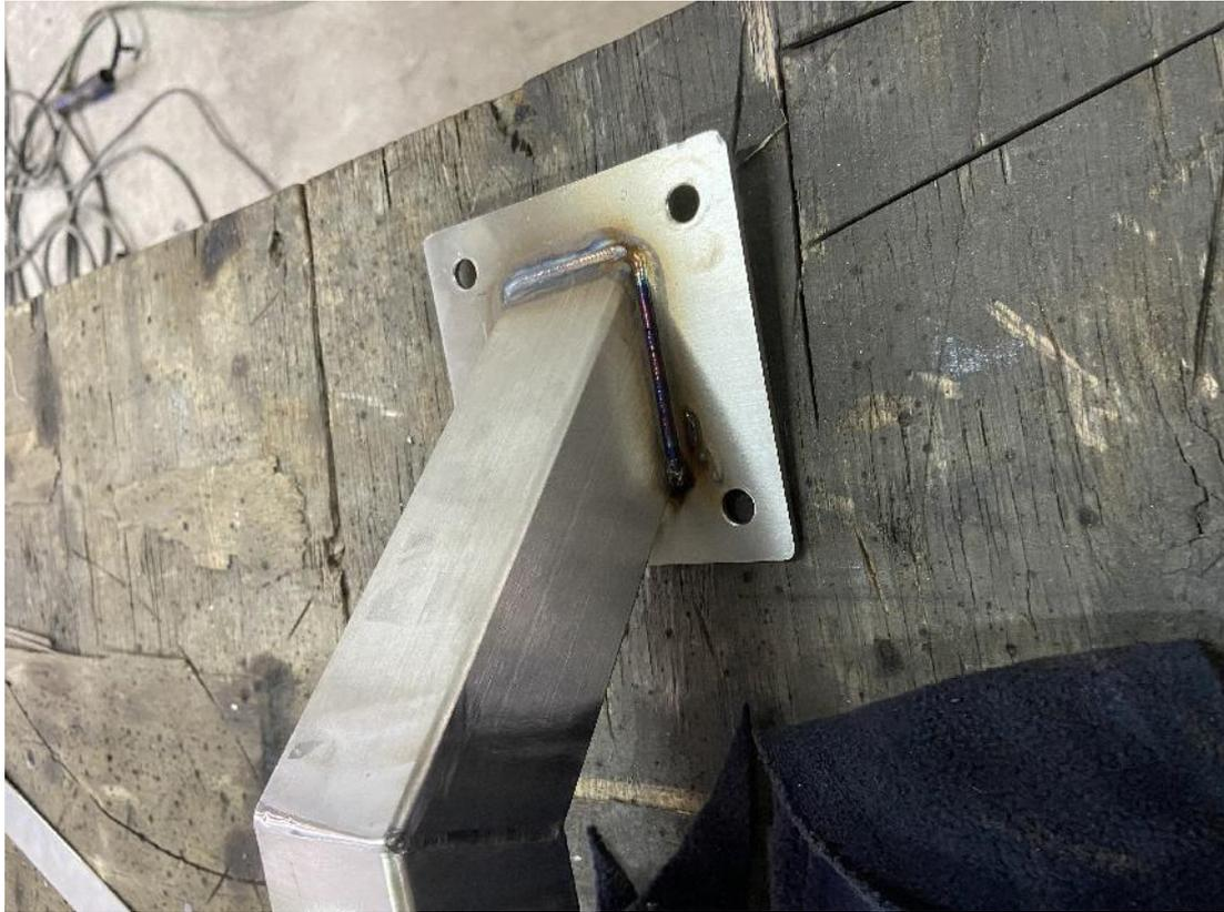
Figura 66. Aplicación de soldadura de placas a tubos cuadrados para confección de bases
