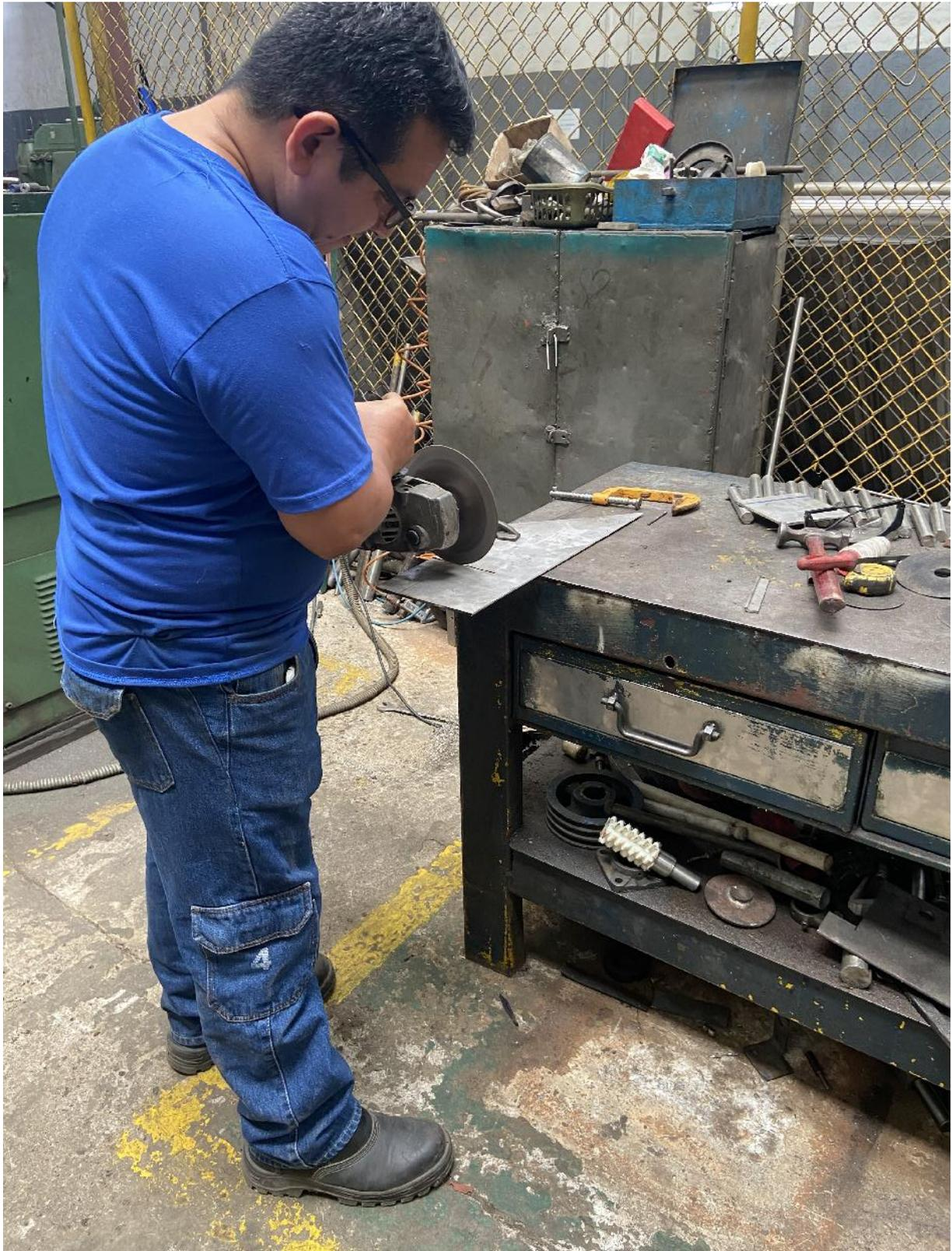
Figura 62. Corte de planchas para conformado de patas
