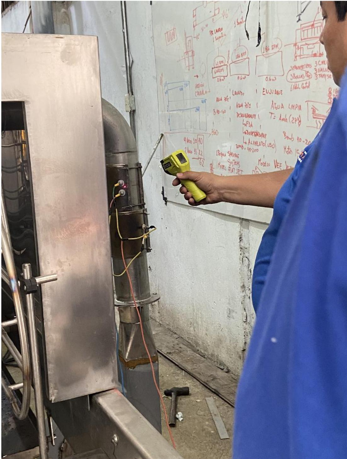
Figura 88. Lectura de temperatura de resistecia para entrega de aire caliente
