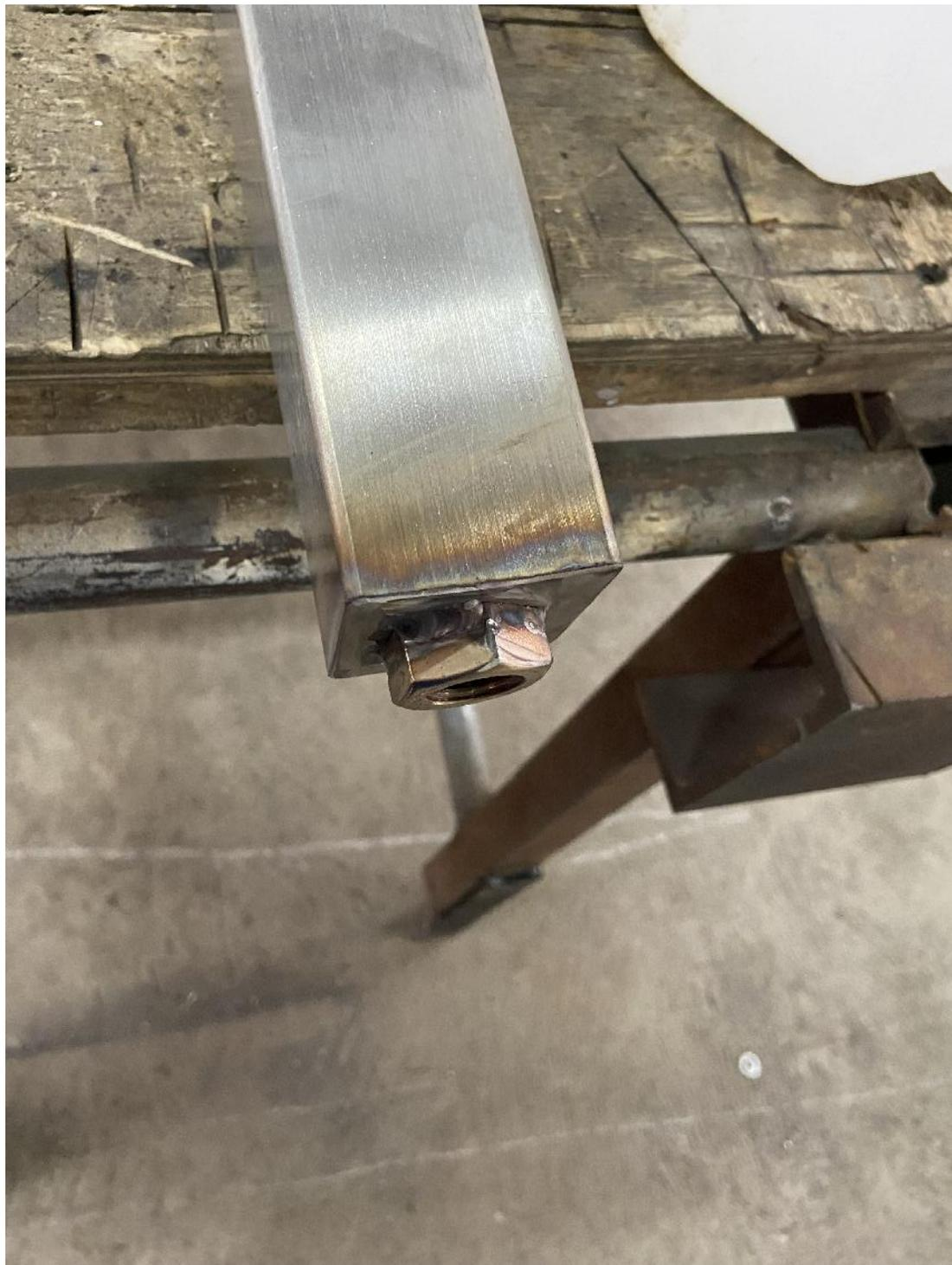
Figura 65. Aplicación de soldadura a tuercas en las bases
