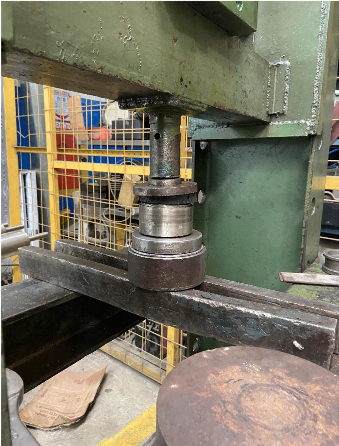
Figura 63. Conformado de patas por medio de prensa hidráulica
