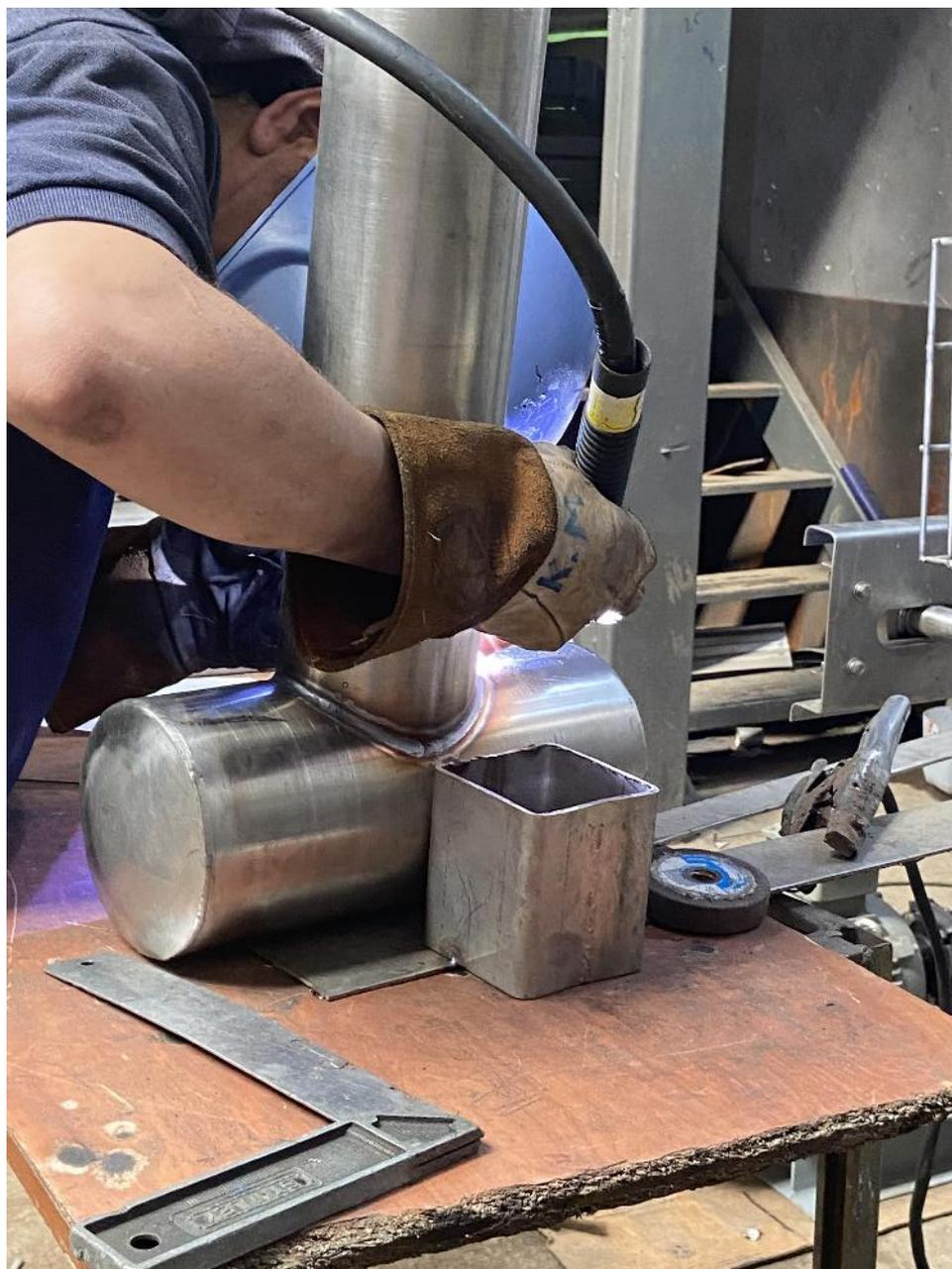
Figura 85. Aplicación de soldadura a ducto distribuidor de aire
