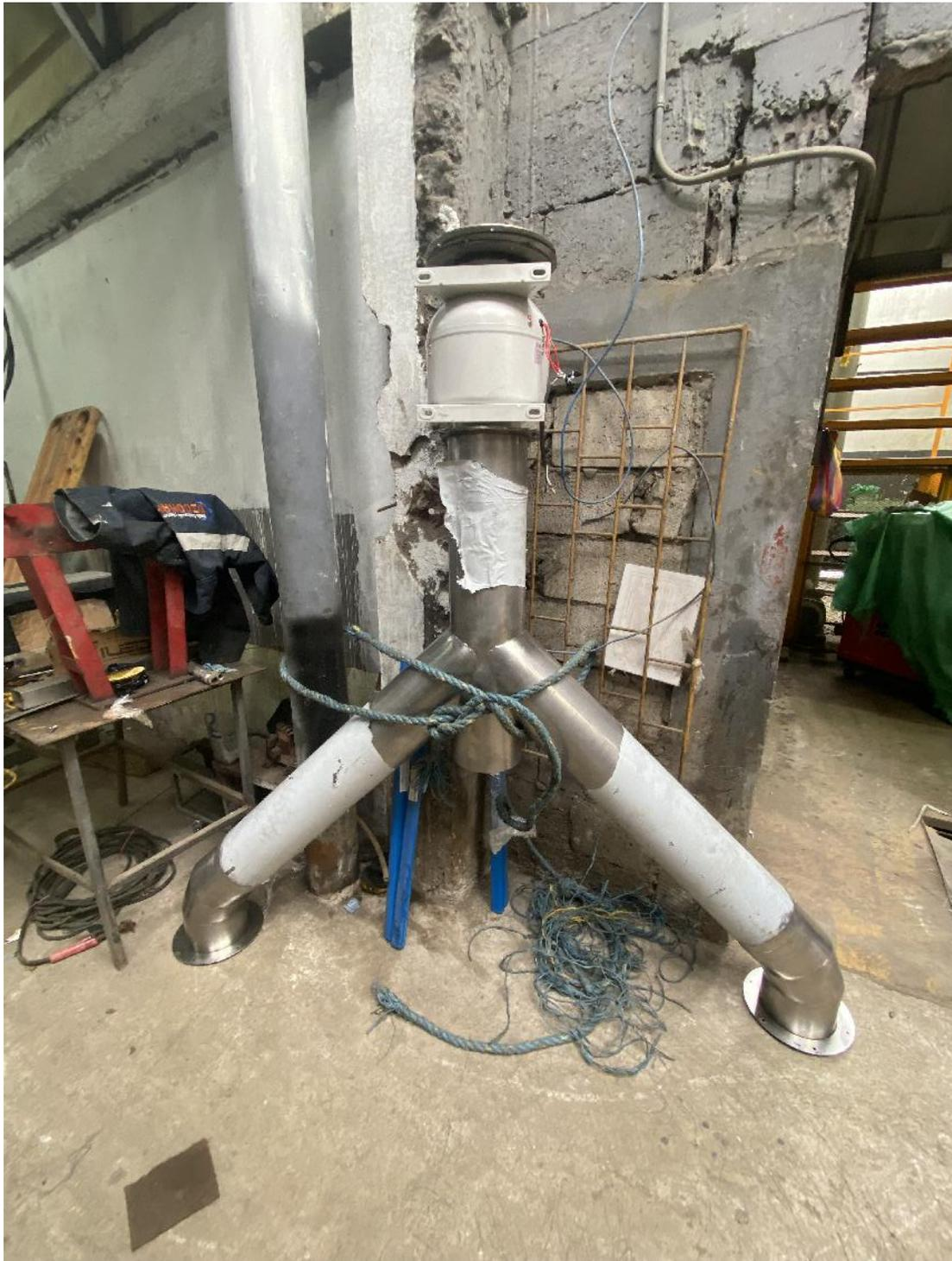
Figura 91. Confección finalizada de ducto de escape de gases
