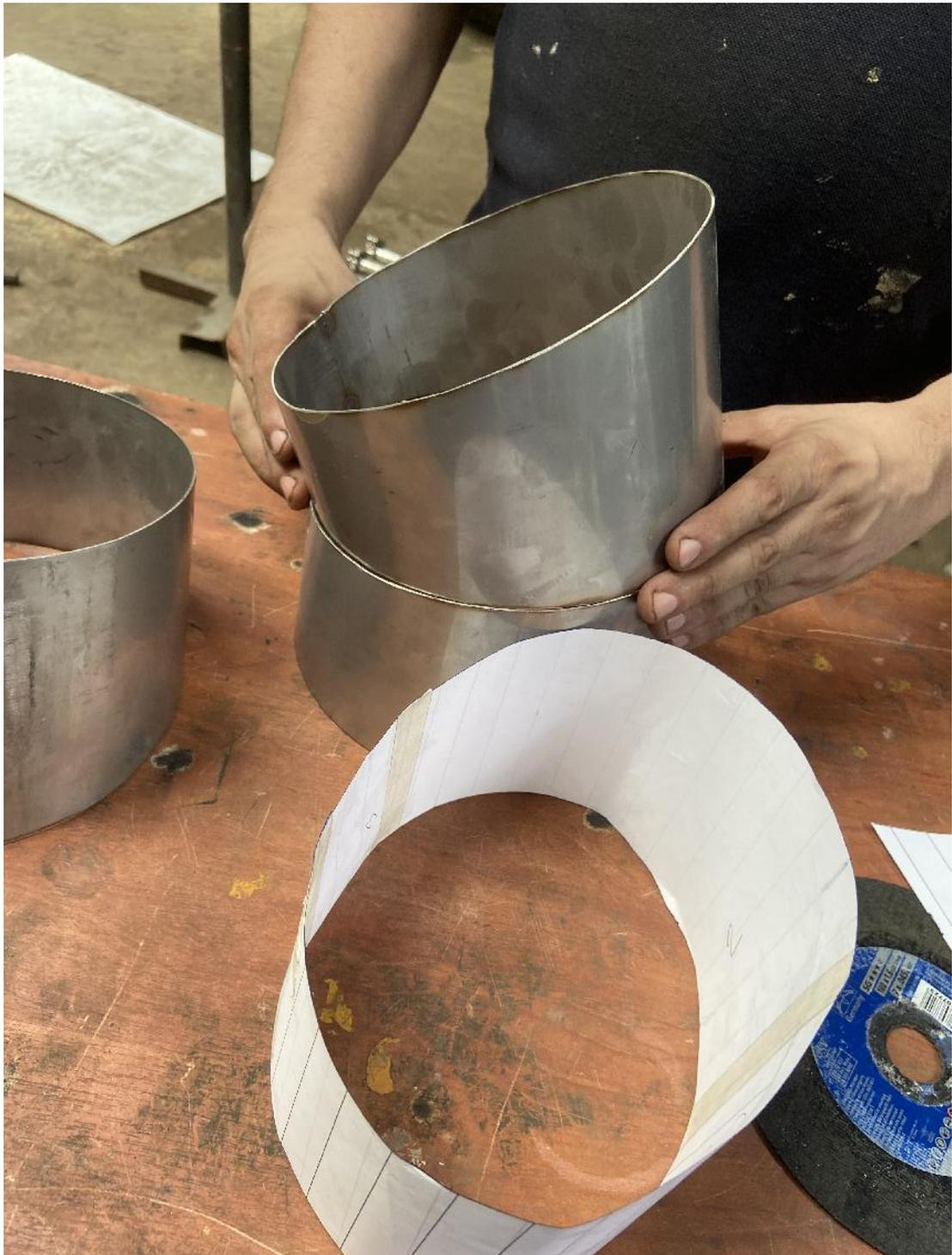
Figura 89. Armado de ducto con molde de acuerdo a diseño 3D
