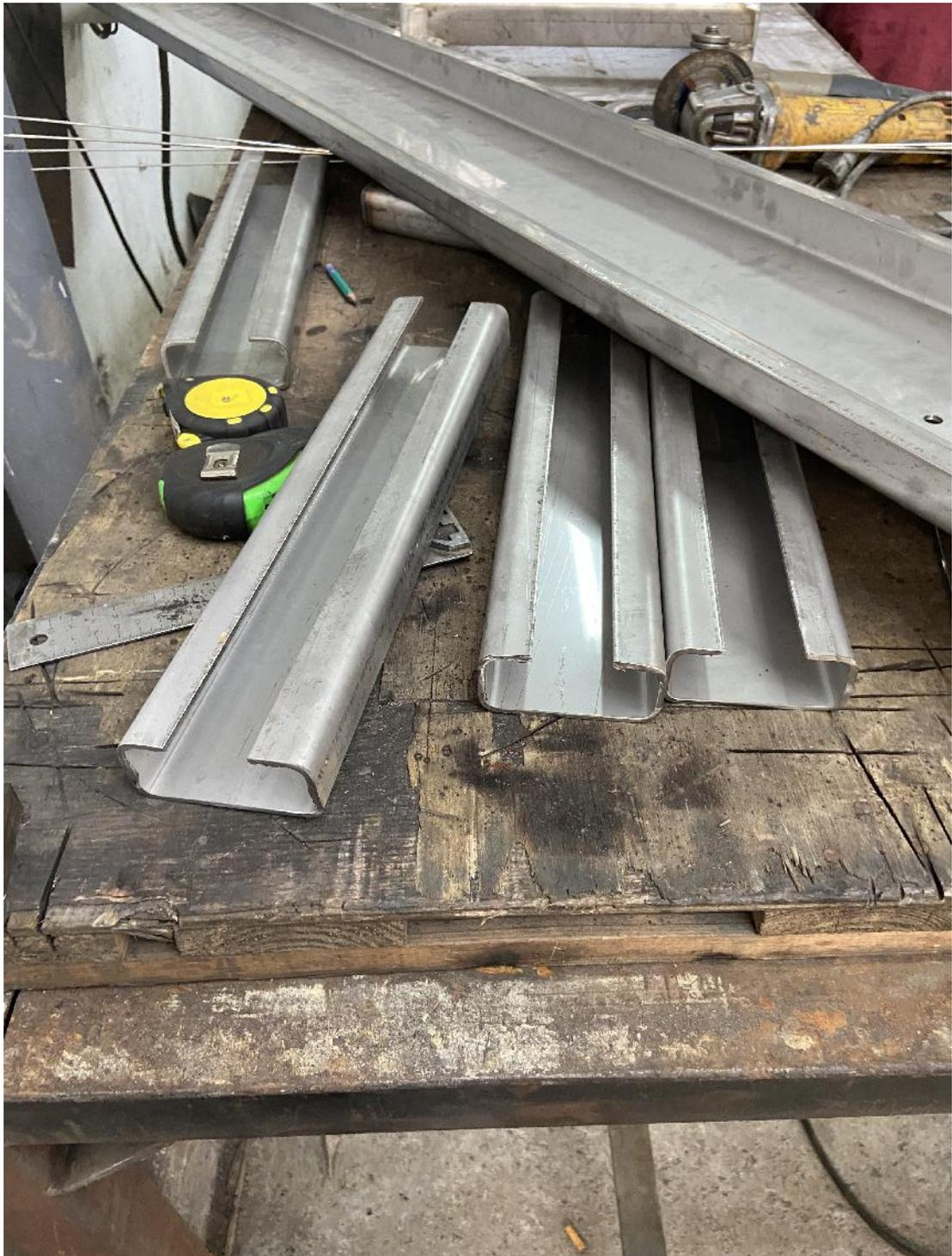
Figura 67. Confección de estructuras para soporte de perfiles.
