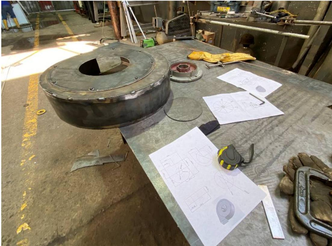
Figura 82. Confección de carcasa para ventilador centrífugo
