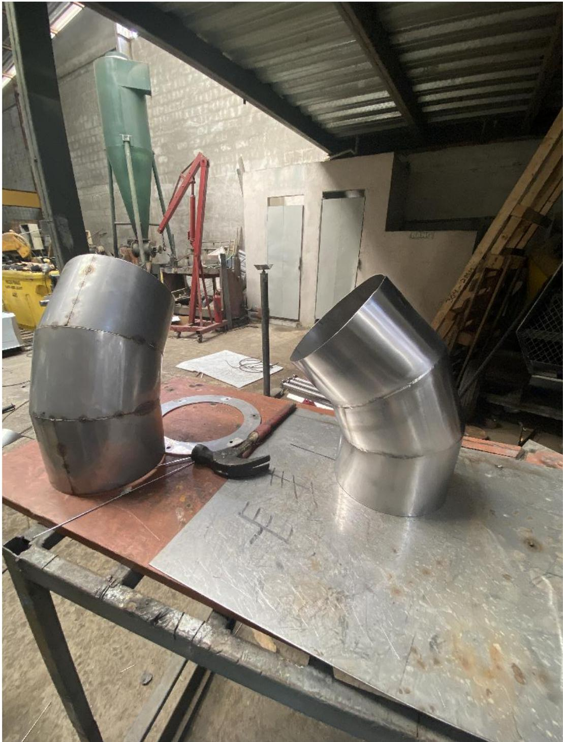
Figura 90. Armado de codos para ducto de escape de gases
