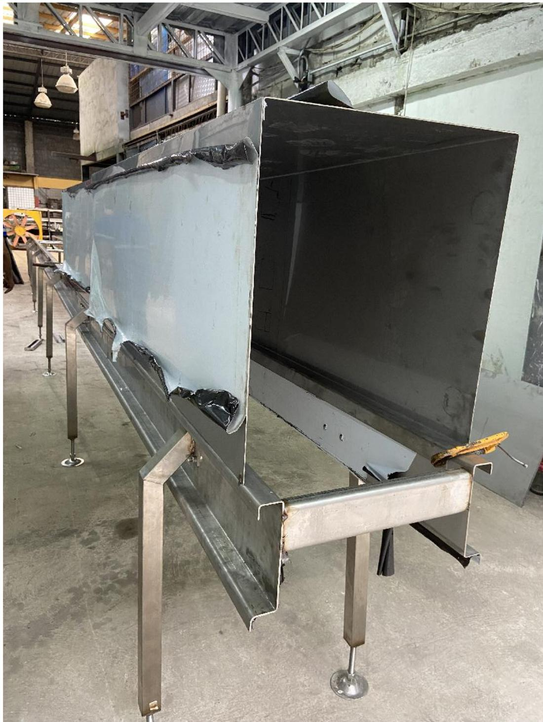
Figura 69. Confección de cabina para lavado y secado
