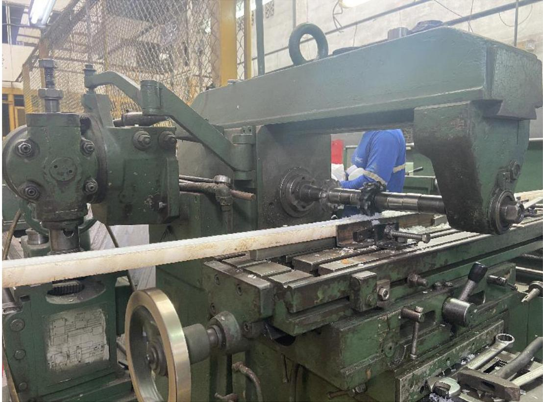
Figura 71. Confección de canal para ubicación de cadena en barra de teflón
