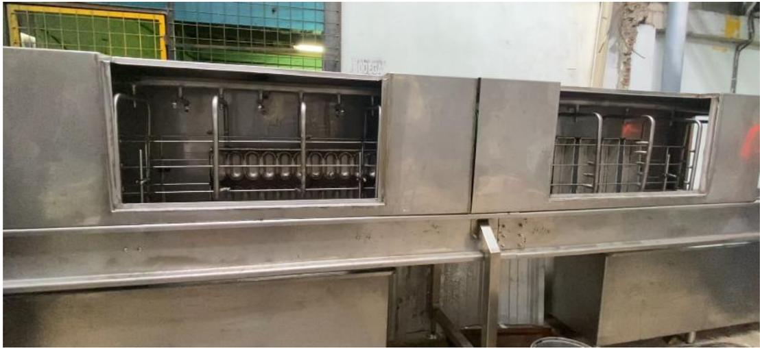
Figura 80. Prueba de transporte de bandejas a través de túnel de lavado
