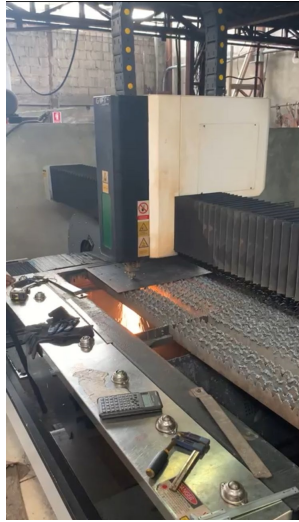
Figura 40. Corte láser Base de hierro para Estructura
