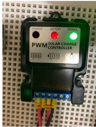
Figura 16. Controlador de carga solar utilizado.
