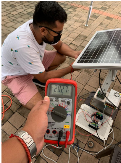
Figura 48. Voltaje Circuito Abierto Del Panel
