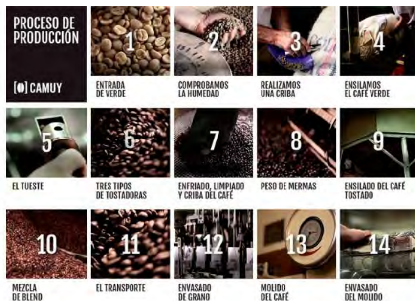
Figura No.49 Proceso de obtención del grano de café
