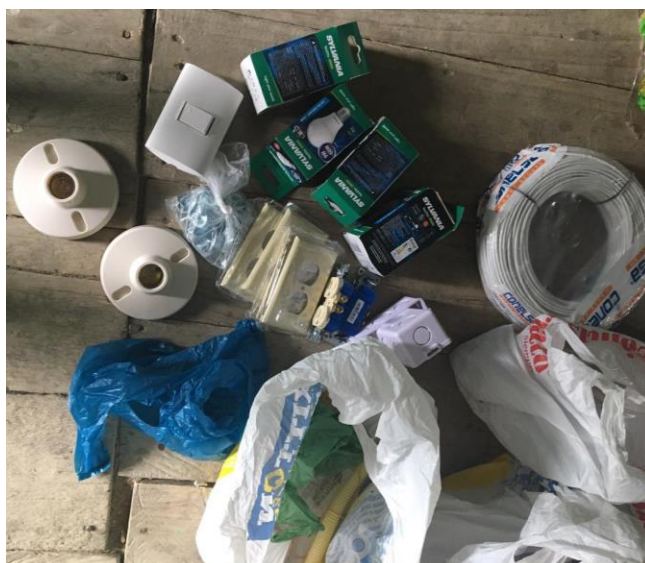
Figura 43 Materiales eléctricos a instalar en hogar
