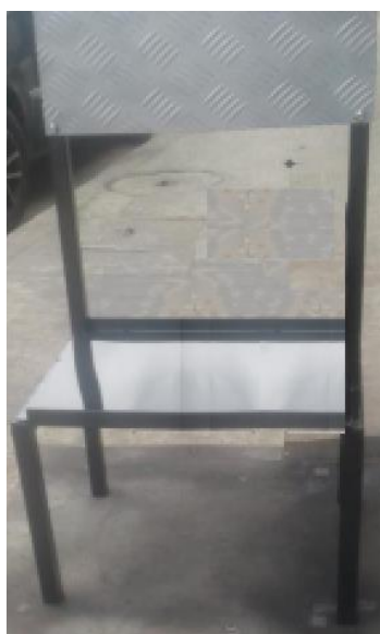
Figura 38 Base para controlar, inversor, baterías.
