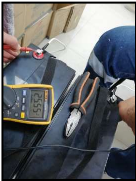
Figura 39: Medición del sistema de batería en serie utilizado para el sistema fotovoltaico, fuente: Autores.
