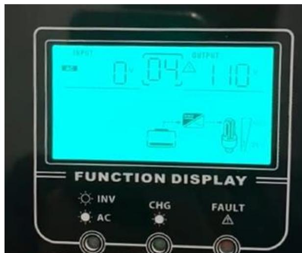
Ilustración 42. Señal de alerta de batería baja.
