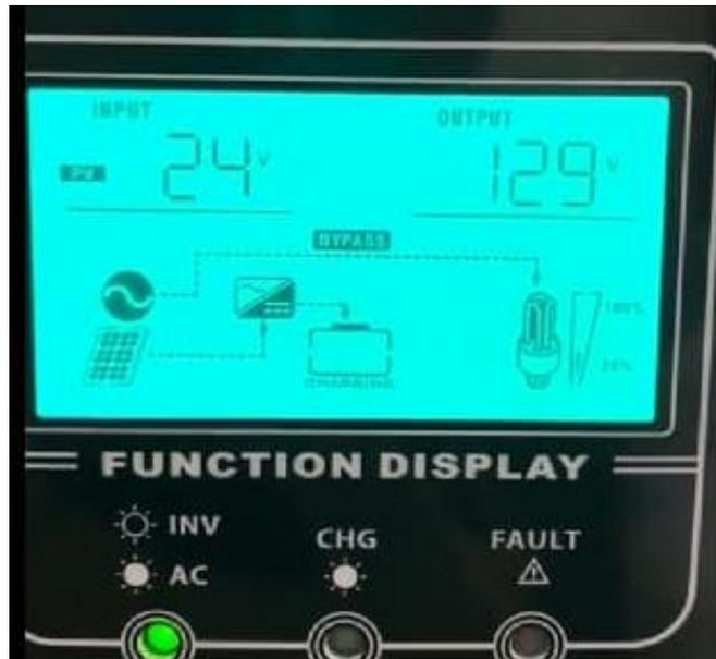
Ilustración 44. Paneles recargando a las baterías.
