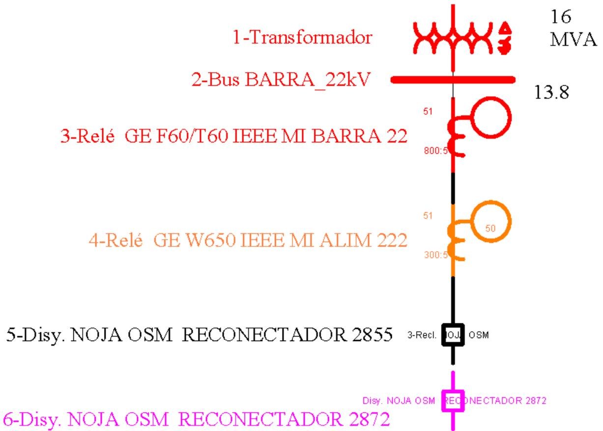
**Figura 70:** Esquema Coordinación de Protecciones Escenario 7
