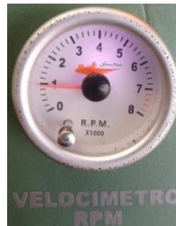
**Observaciones:** Para obtener los mismos resultados del tablero y el programa se debe ubicar de una manera adecuada el sensor de revoluciones.
