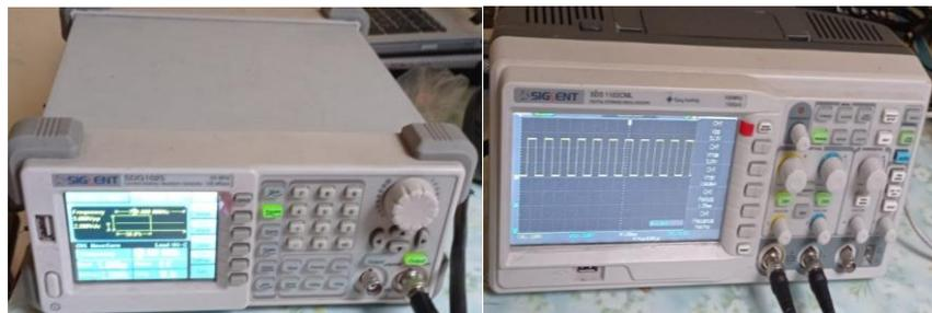
**Figura 3.28** Toma de señal cuadrada en un osciloscopio (RPM).
