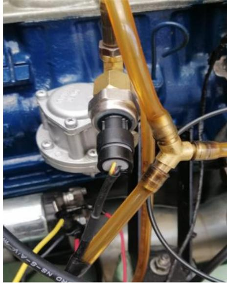
**Figura 3.20** Implementación del sensor de presión de combustible en el motor.
