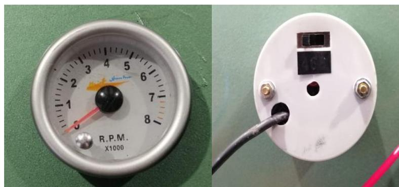
**Figura 2.40** Medidor de las revoluciones (RPM).
