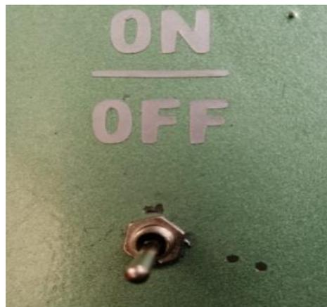
**Figura 4.8** Sistema de apagado de emergencia.
