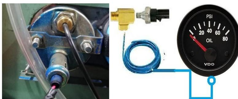
**Figura 2.45** Esquema de conexión de la presión de aceite.
