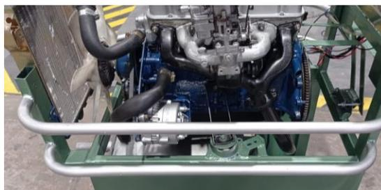
*Figura 2.28 Guardas de seguridad*
