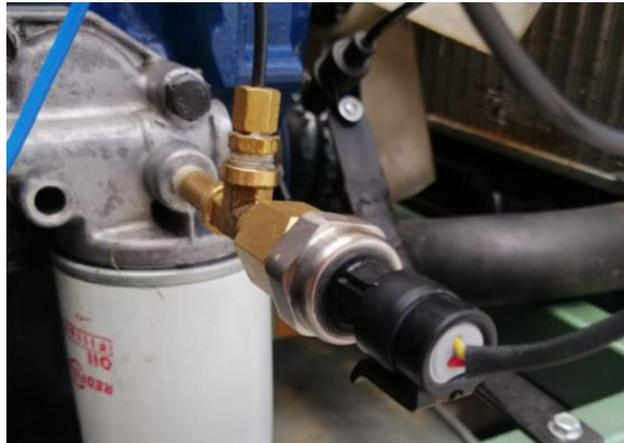
**Figura 3.16** Implementación del sensor de presión de aceite en el motor.
