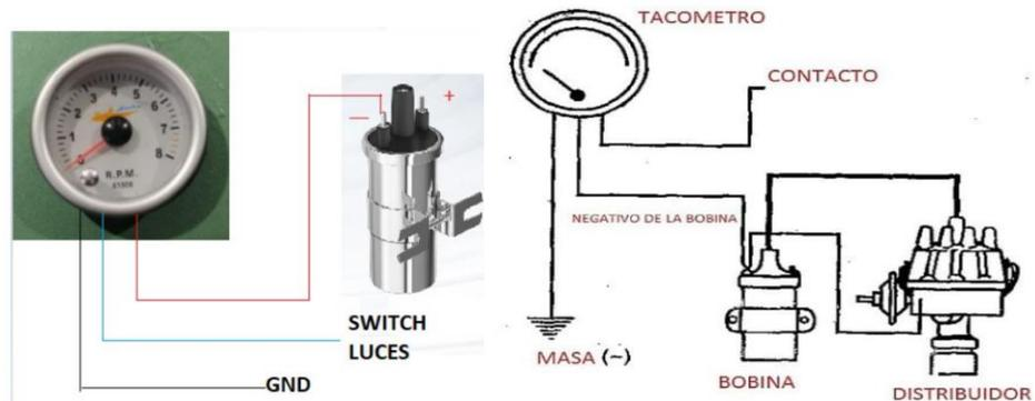
**Figura 2.39** Diagrama del medidor de las RPM.
