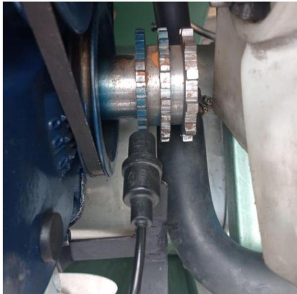
**Figura 3.30** Implementación del sensor de revoluciones (RPM) en el motor. **Fuente:** Autores.
