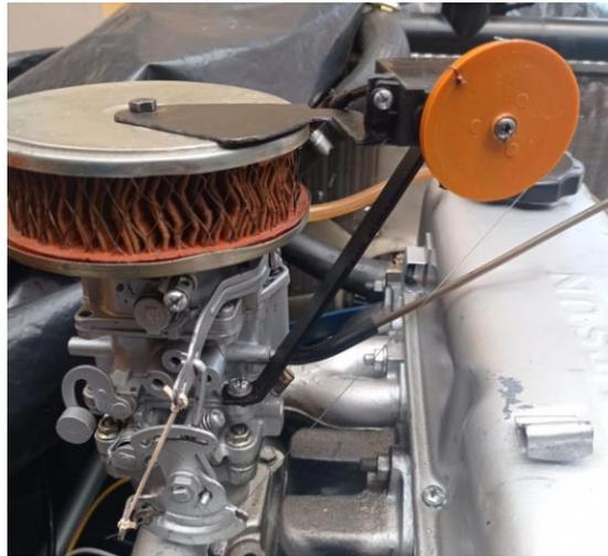
**Figura 3.38** Implementación del servo motor en el banco didáctico del motor Nissan A10.
