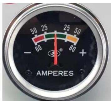
**Figura 2.52** Indicador carga de la batería.
