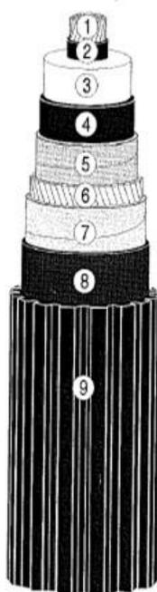
Figura 3.11: Corte del cable 1x500mm<sup>2</sup> aluminio XLPE 230 Kv. Fuente: CELEC EP.[11]
