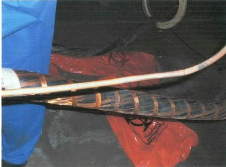
Figura 3.19: Corte real del cable a 138KV de la unidad 4. Fuente: Celec
