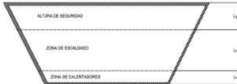
Figura 20: Altura de la tina de escaldado .
