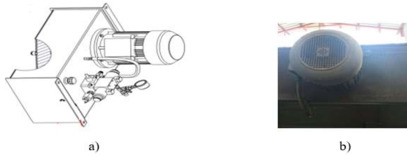
Figura 32. Motor principal de la plegadora. a) Bosquejo ortogonal b) Fotografía digital de la máquina emplazada en la empresa
