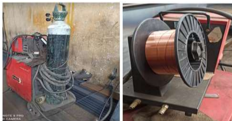
Figura 9. Soldadora de gas inerte de molibdeno (MIG) modelo TL-3
