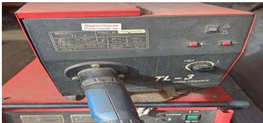
Figura 17. Reguladores de corriente, tensión y velocidad del material de aportación MIG.
