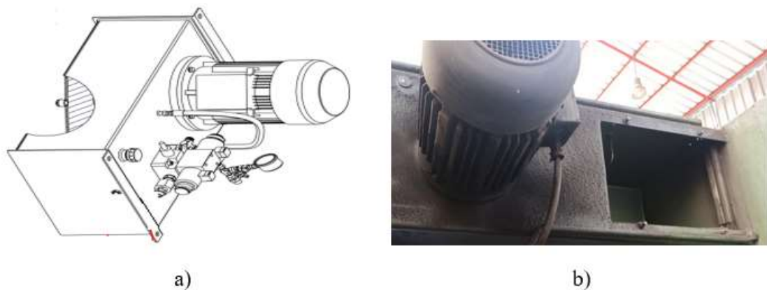
Figura 25. Motor principal de la máquina cizalla hidráulica. a) Bosquejo ortogonal b) Fotografía digital de la máquina emplazada en la empresa.
