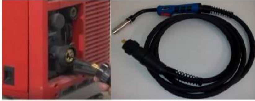
Figura 15. Tubería desprendible de la soldadora MIG.
