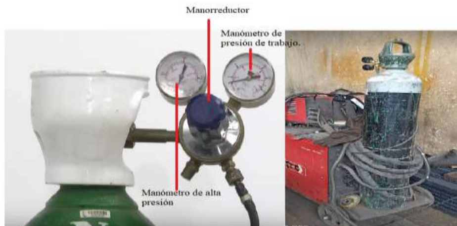
Figura 14. Conjunto de seguridad de la botella de gas MIG.
