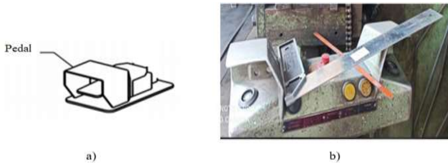
Figura 33. Controles de la cuchilla de la plegadora. a) Bosquejo ortogonal b) Fotografía digital de la máquina emplazada en la empresa
