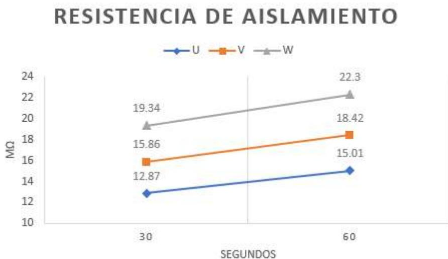
Figura 41: Resistencia de Aislamiento Fase a Tierra del Malacate 1
