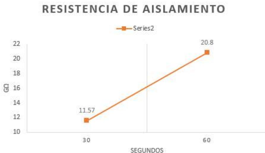
Figura 38: Resistencia de Aislamiento Fase a Tierra de la Bomba
