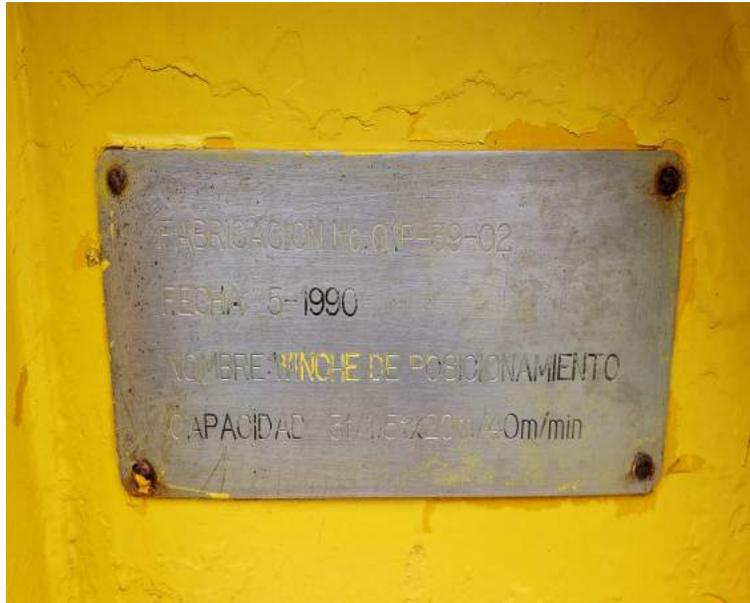
Figura 57: Placa Winche de Posicionamiento 3
