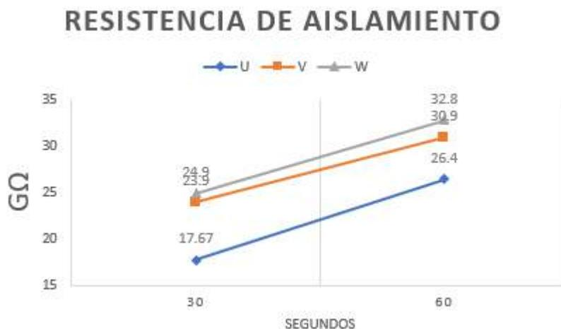
Figura 39: Resistencia de Aislamiento Fase a Tierra del Transformador en Alta
