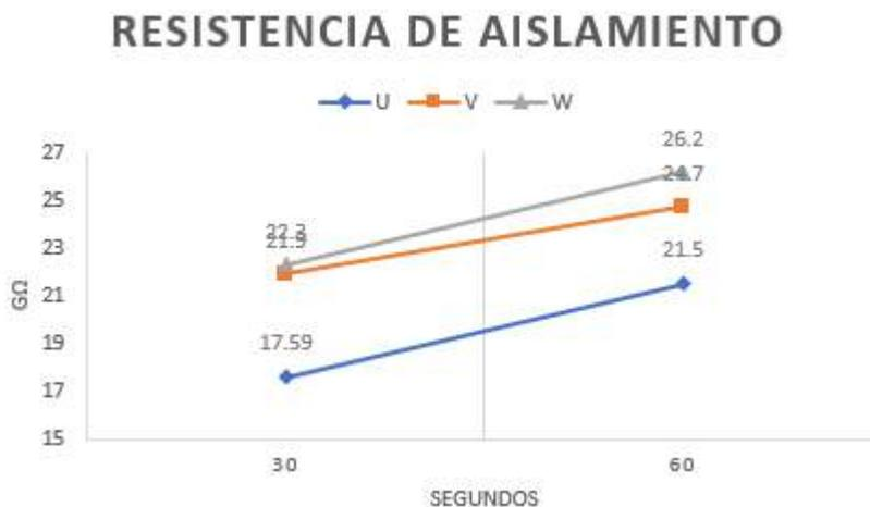
Figura 40: Resistencia de Aislamiento Fase a Tierra del Transformador en Alta-Baja
