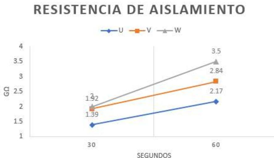
Figura 42: Resistencia de Aislamiento Fase a Tierra del Malacate 2
