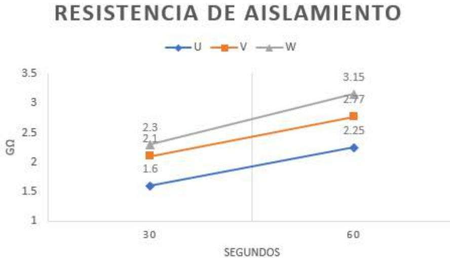
Figura 44: Resistencia de Aislamiento Fase a Tierra del Malacate 4
