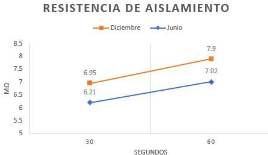
Figura 35: Resistencia de Aislamiento Fase a Tierra del Motor de Dragado
