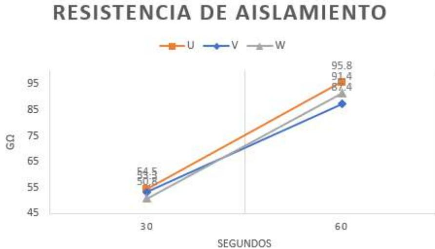
Figura 37: Resistencia de Aislamiento Fase a Tierra de la Nueva Bomba de Chorro
