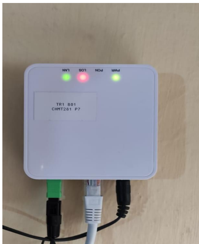
Ilustración 4.1.3:5 ONU reflejando un estado en LOS.
