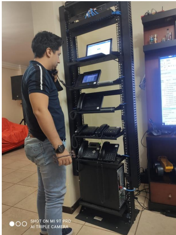
Figura 4.17 Pruebas de tono en teléfonos VOIP
