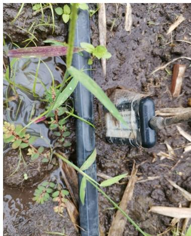
**Fig. 19** Sensor de humedad instalado en el suelo.
