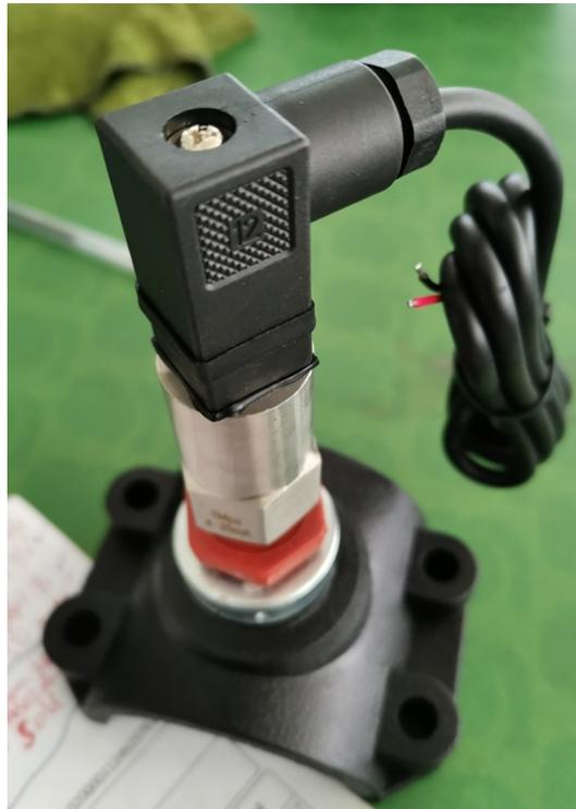
**Fig. 20** Sensor de presión absoluta, montado en un collarín.
