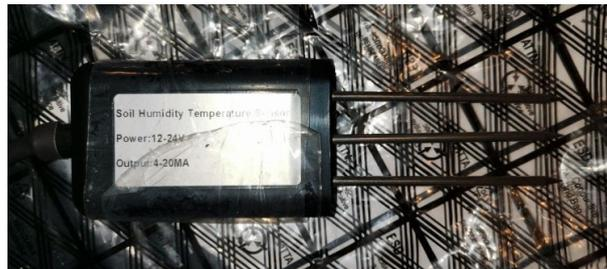
**Fig. 48** Sensor de humedad.
